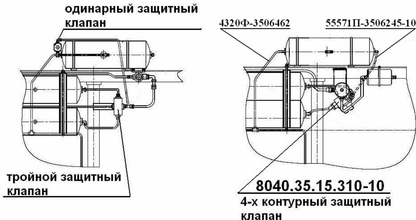
Рис. 15 Установка воздушных баллонов
