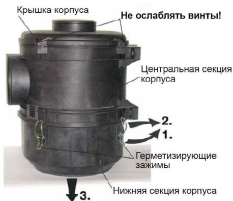
Рисунок 5.5 - Снятие нижней секции корпуса
