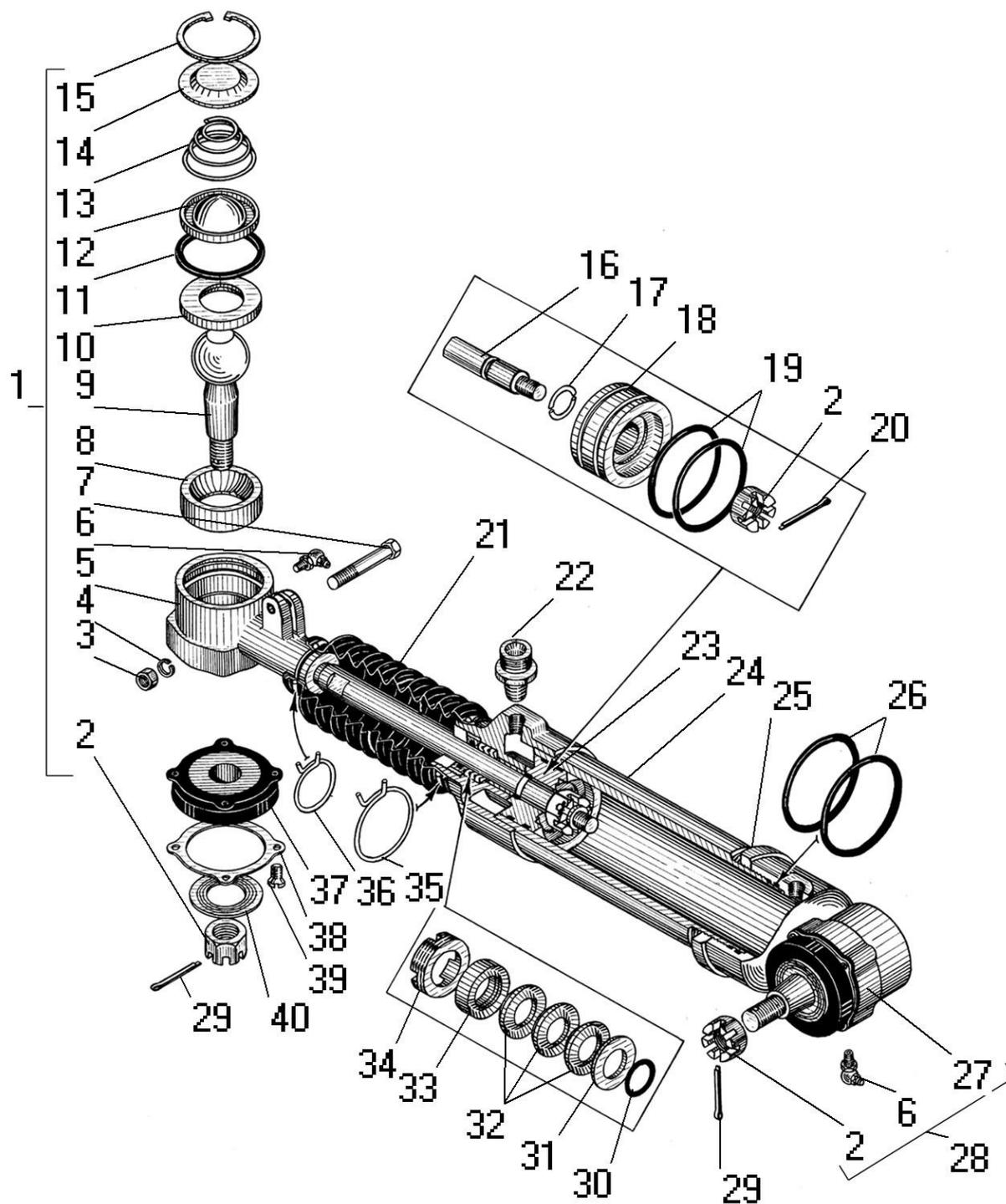
Рисунок 62 - Усилительный механизм
