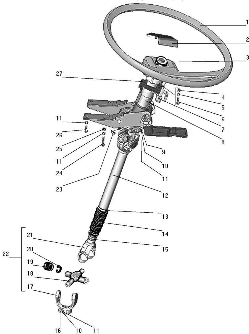
Рисунок 61 - Колесо и вал рулевого управления
