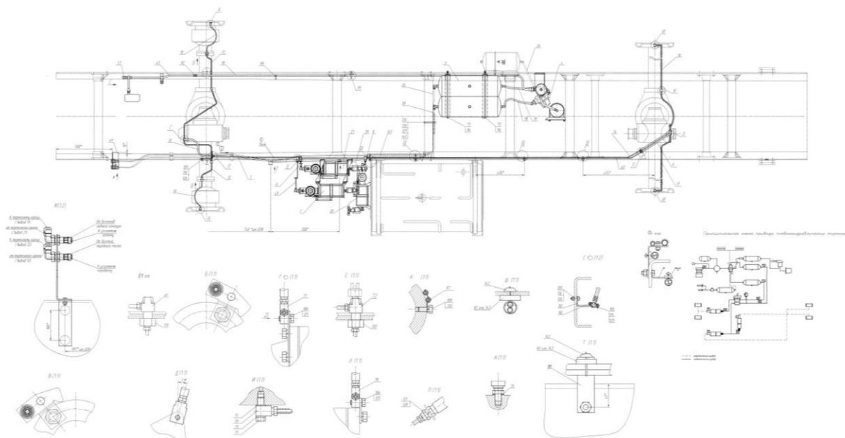
Рисунок 77 - Установка агрегатов гидропневматического привода рабочих тормозов
