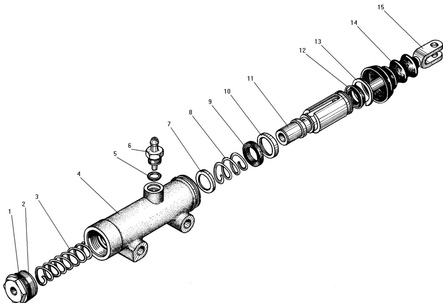
Рисунок 24 - Цилиндр гидравлический
