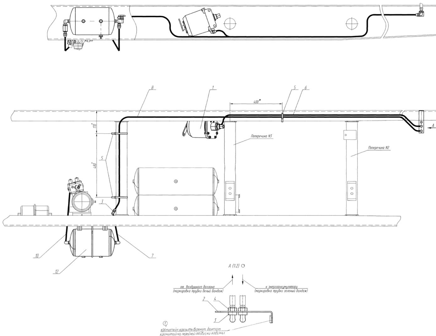
Рисунок 73 - Установка пневмопривода стояночного тормоза
