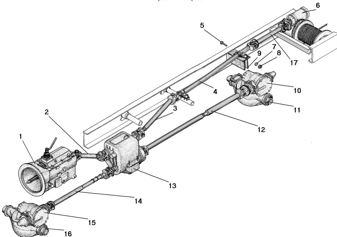
Рисунок 33 - Карданная передача
