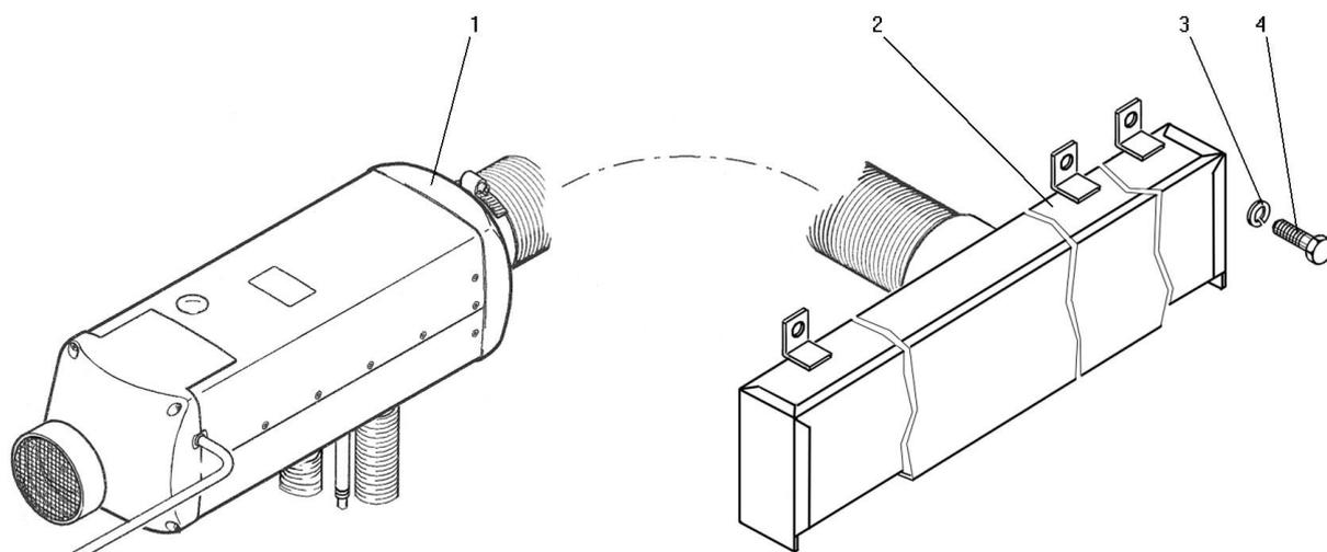
Рисунок 120 - Установка независимого отопителя
