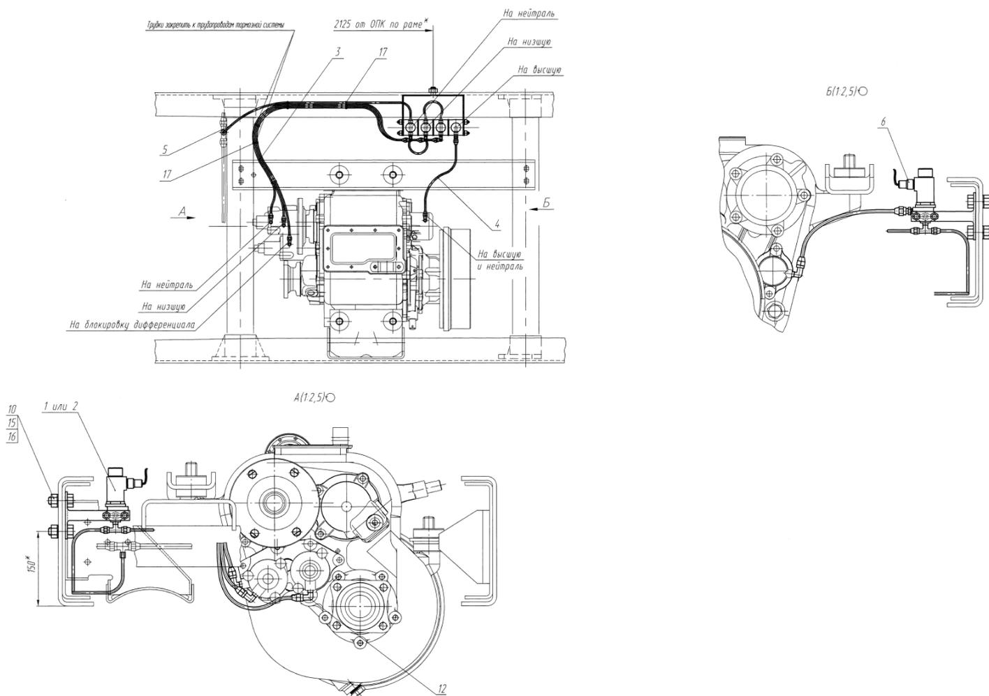
Рисунок 32 - Управление и механизм переключения раздаточной коробки
