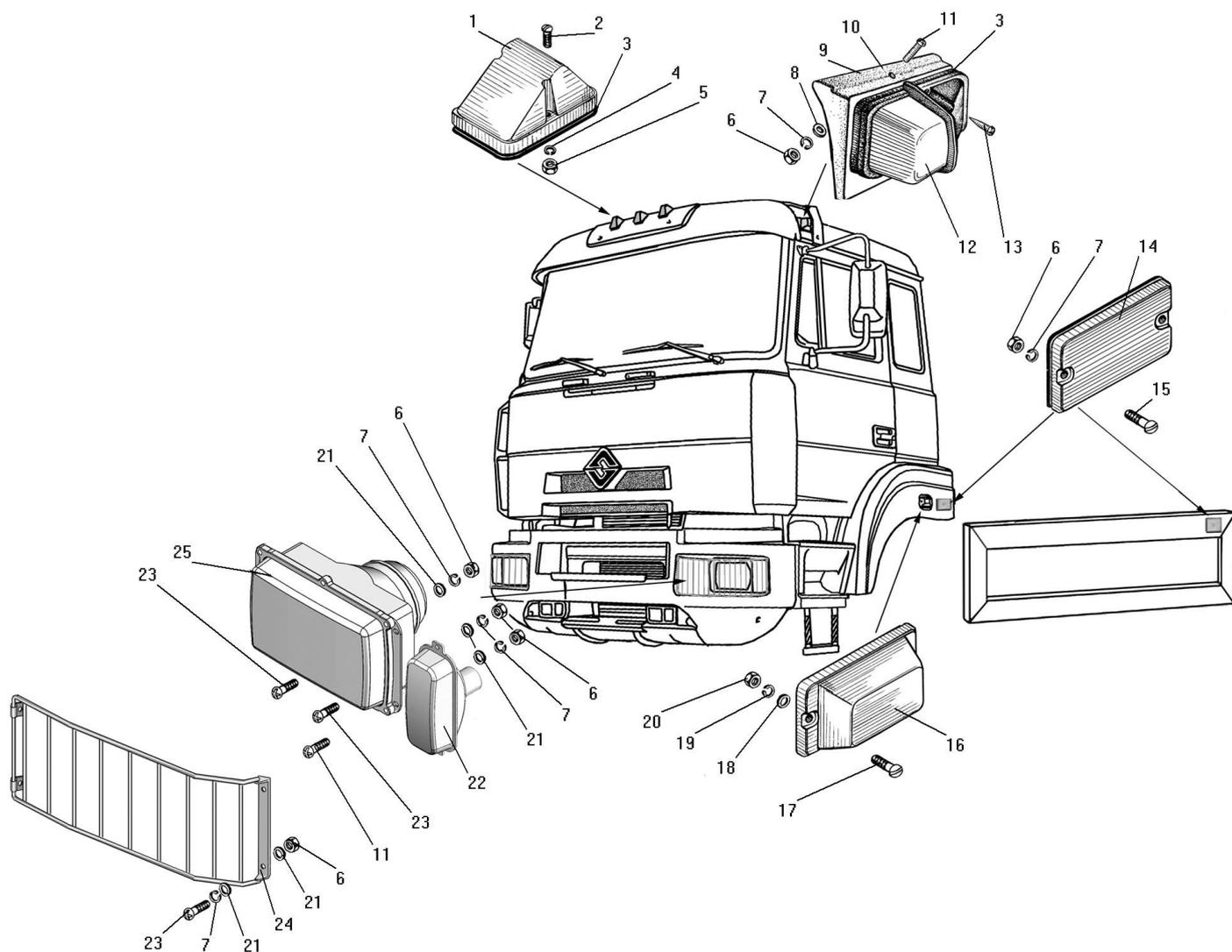
Рисунок 94 - Установка фары, фонарей знака автопоезда, освещения подножек, габаритных и указателей поворота
