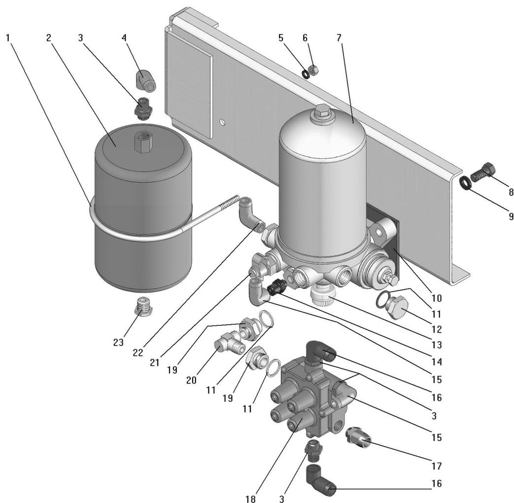
Рисунок 79 - Установка блока подготовки воздуха
