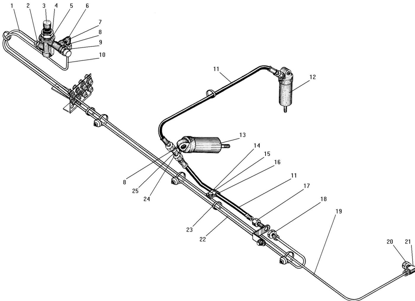
Рисунок 89 - Система вспомогательного тормоза
