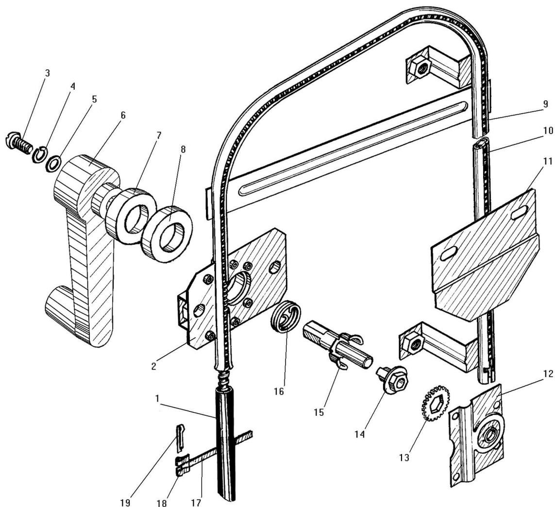
Рисунок 117 - Стеклоподъемник
