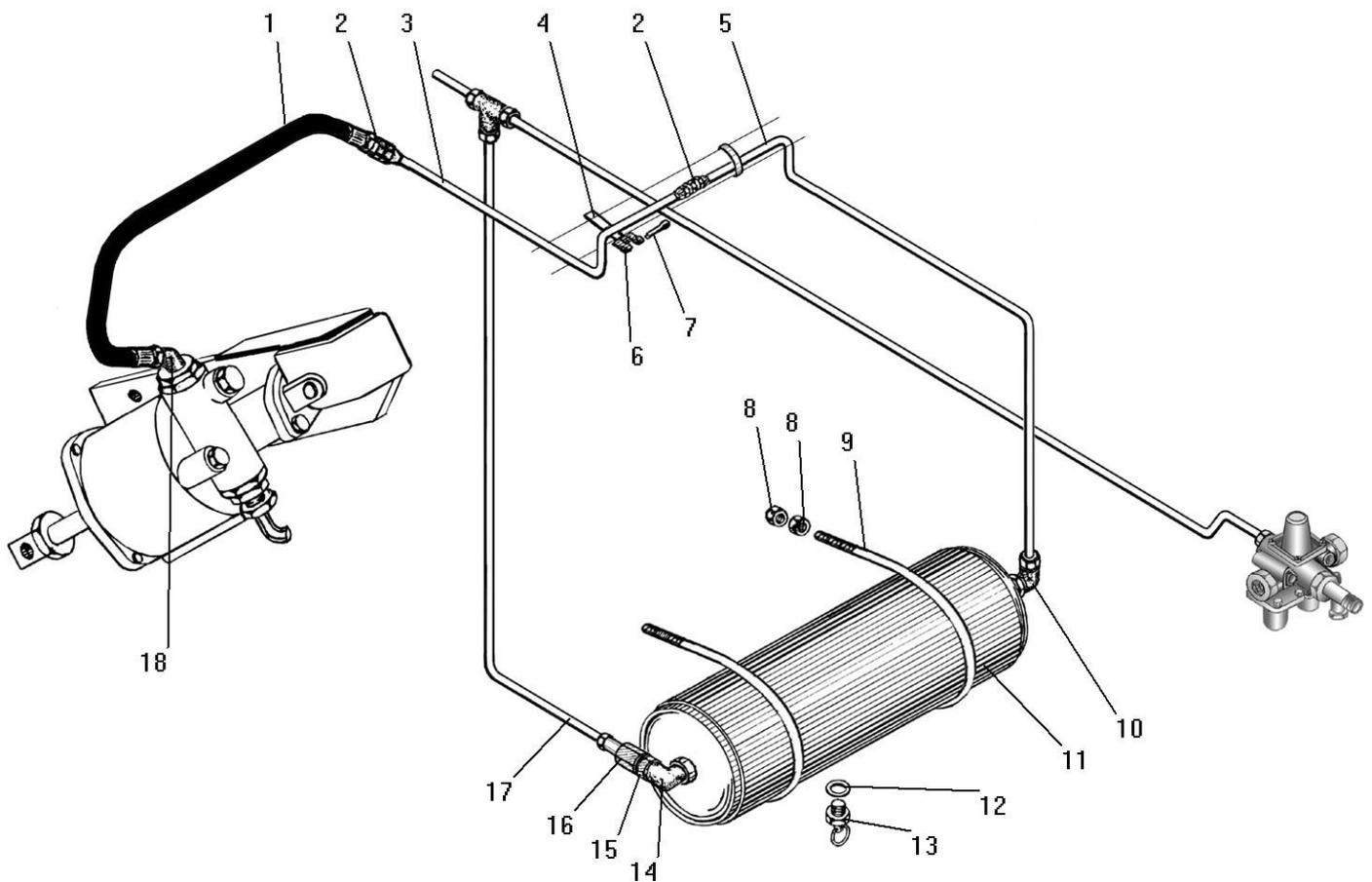
Рисунок 22 - Пневмопривод выключения сцепления
