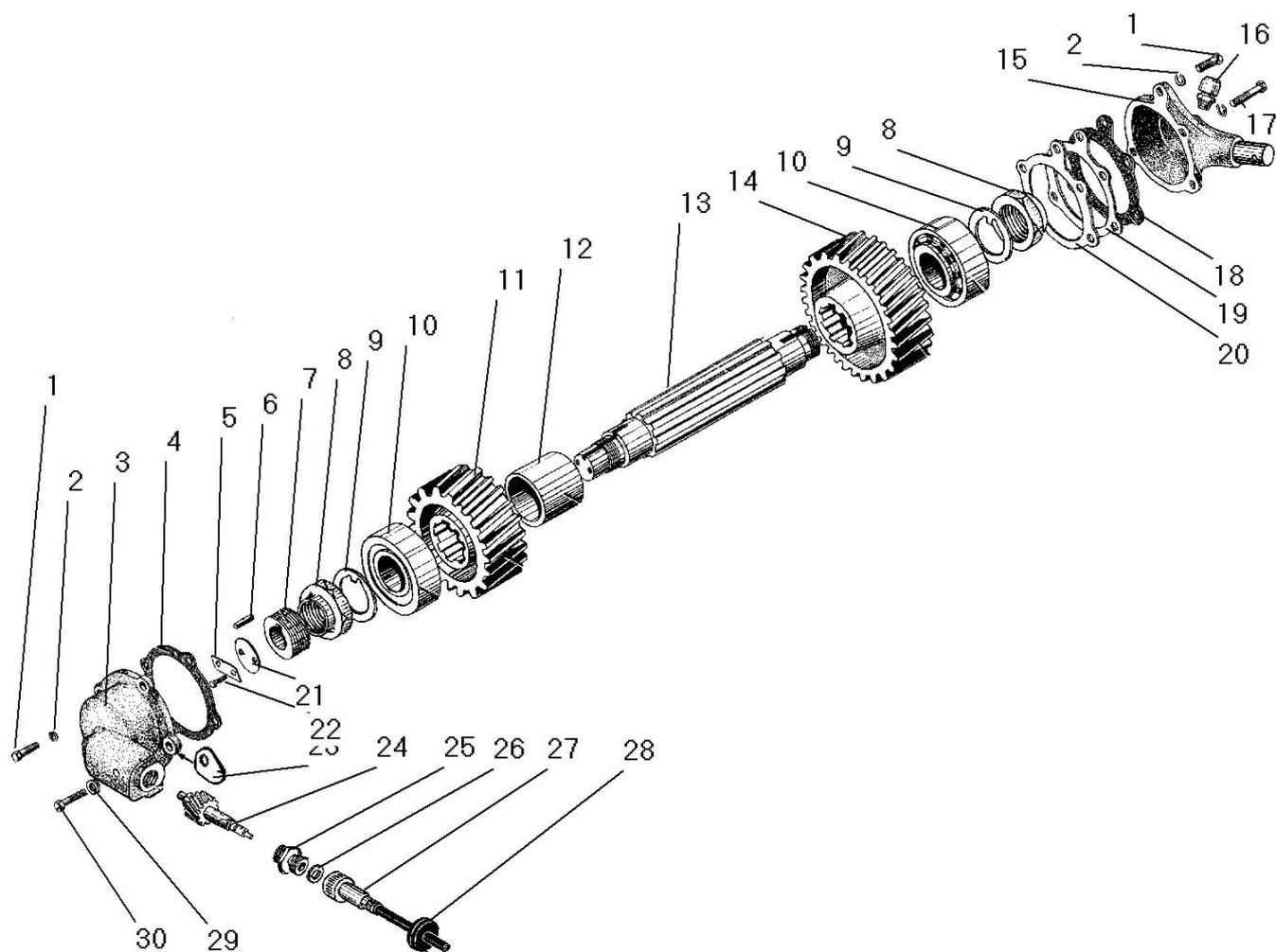
Рисунок 29 - Промежуточный вал раздаточной коробки и привод спидометра
