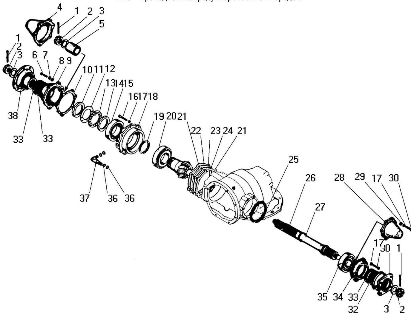
Рисунок 40 - Проходной вал редуктора главной передачи
