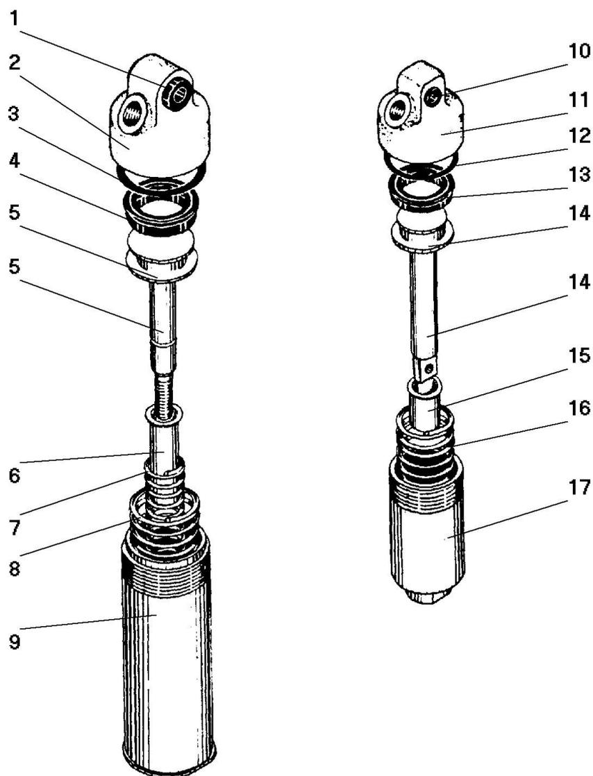
Рисунок 90 - Пневматические цилиндры вспомогательного тормоза
