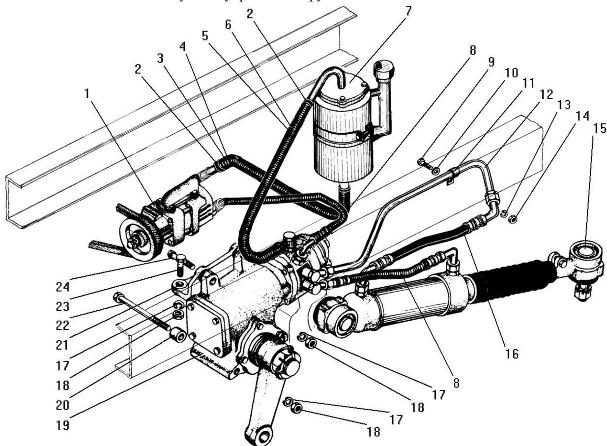
Рисунок 57 - Рулевое управление с рулевым механизмом 55557Я-3400020
