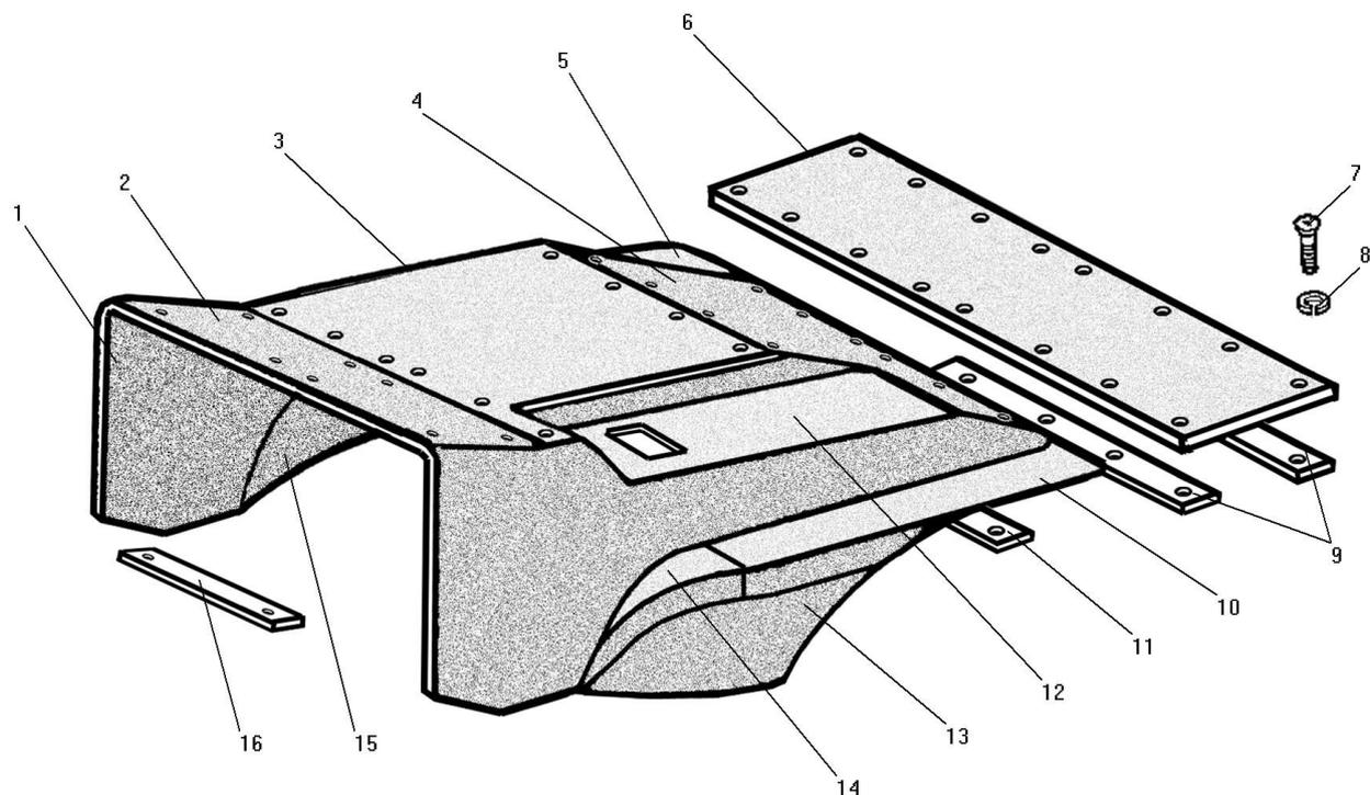
Рисунок 106 - Изоляция мотоотсека наружная
