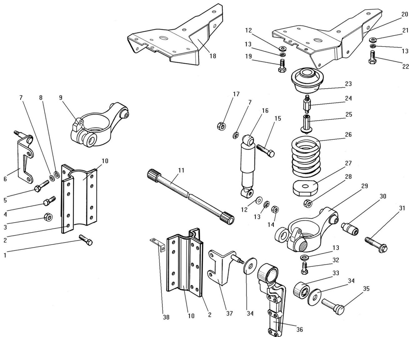
Рисунок 103 - Опора кабины передняя
