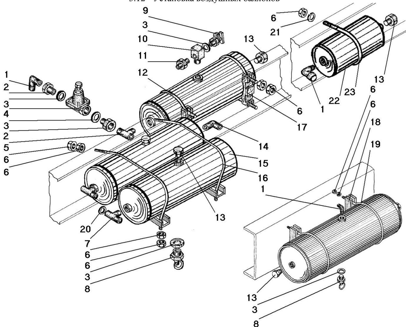
Рисунок 78 - Установка воздушных баллонов
