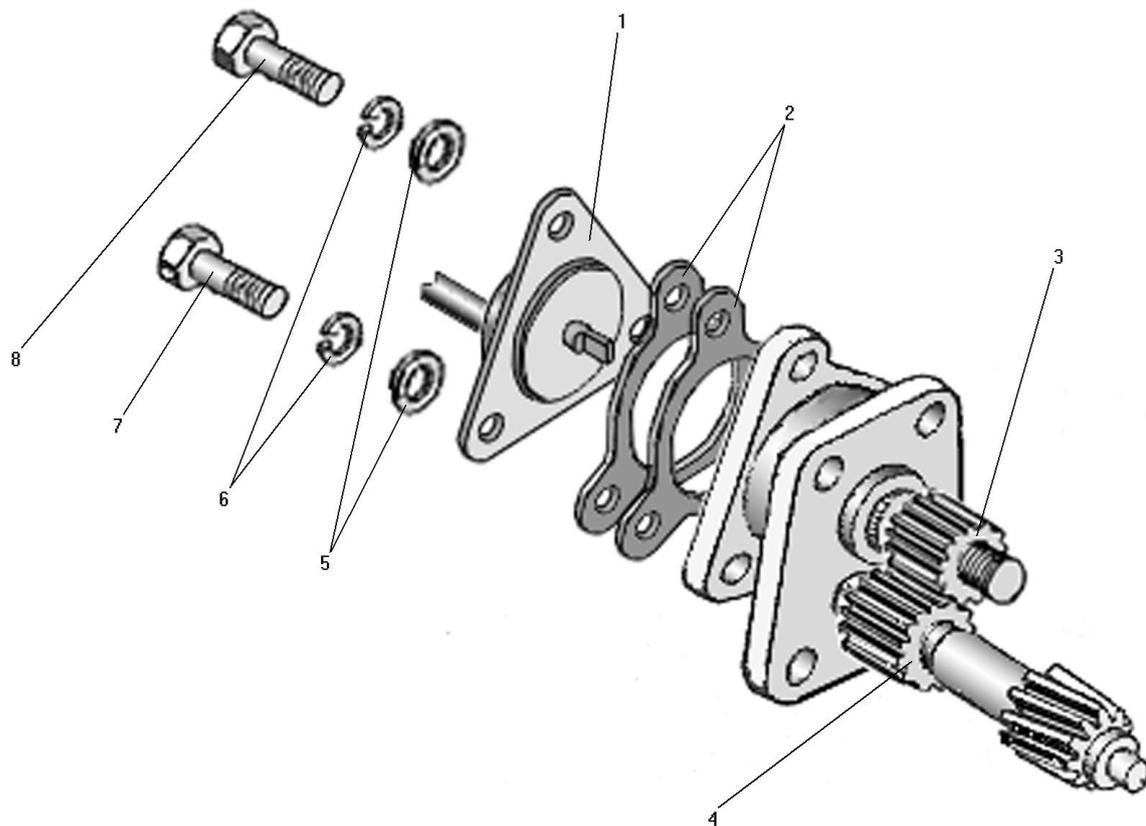
Рисунок 27 - Привод спидометра
