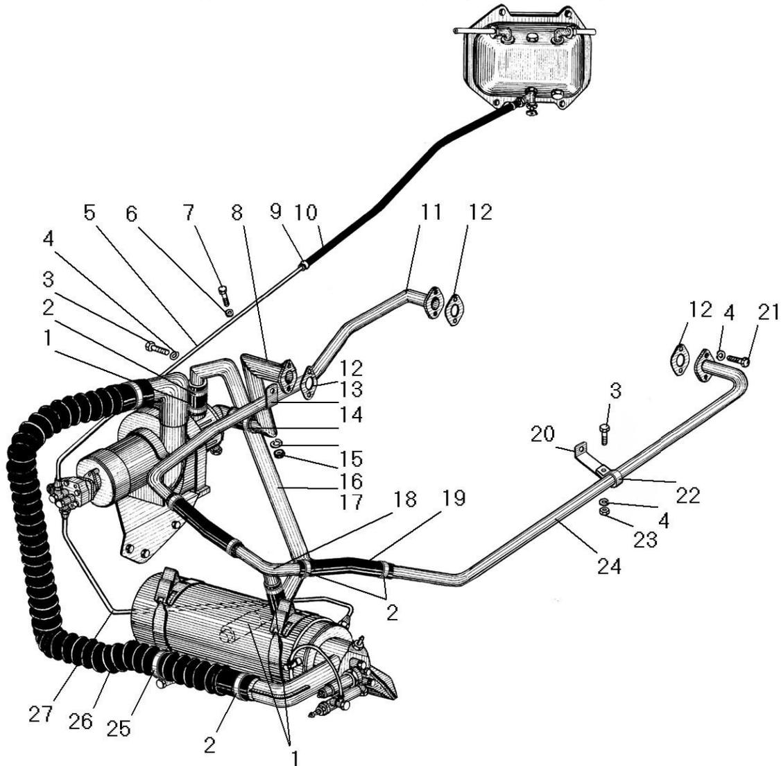
Рисунок 5 - Трубы и шланги системы предпускового подогрева
