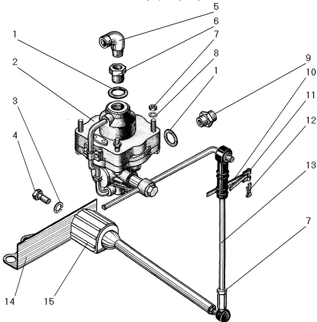
Рисунок 92 - Установка регулятора тормозных сил
