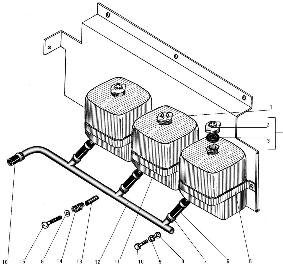
Рисунок 20 - Расширительный бачок
