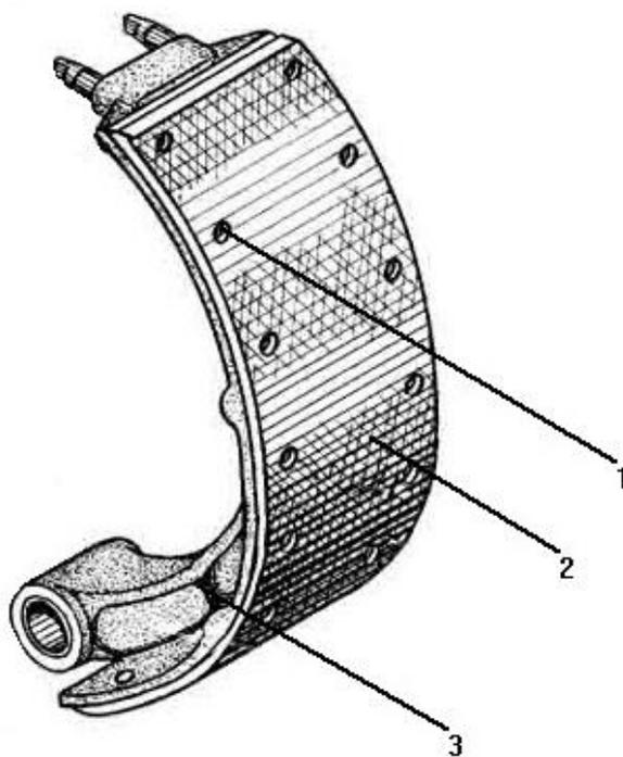
Рисунок 69 - Колодка тормоза в сборе 55571-3501090-20
