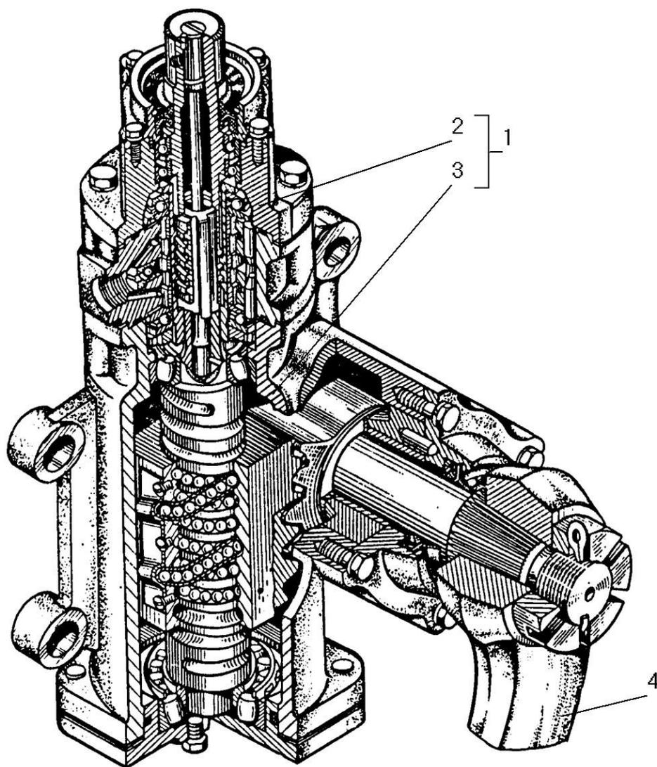
Рисунок 58 - Механизм рулевой с распределителем
