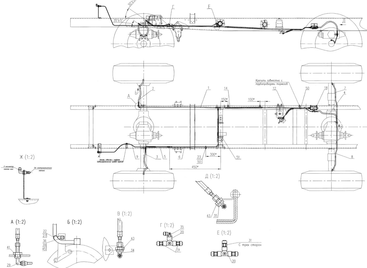
Рисунок 55 - Система регулирования давления воздуха в шинах
