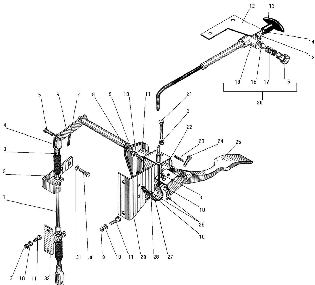
Рисунок 12 - Привод акселератора
