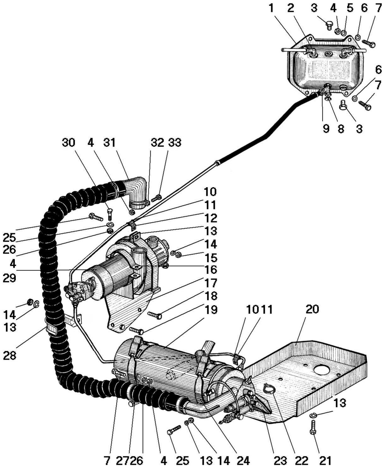
Рисунок 4 - Установка агрегатов системы предпускового подогрева
