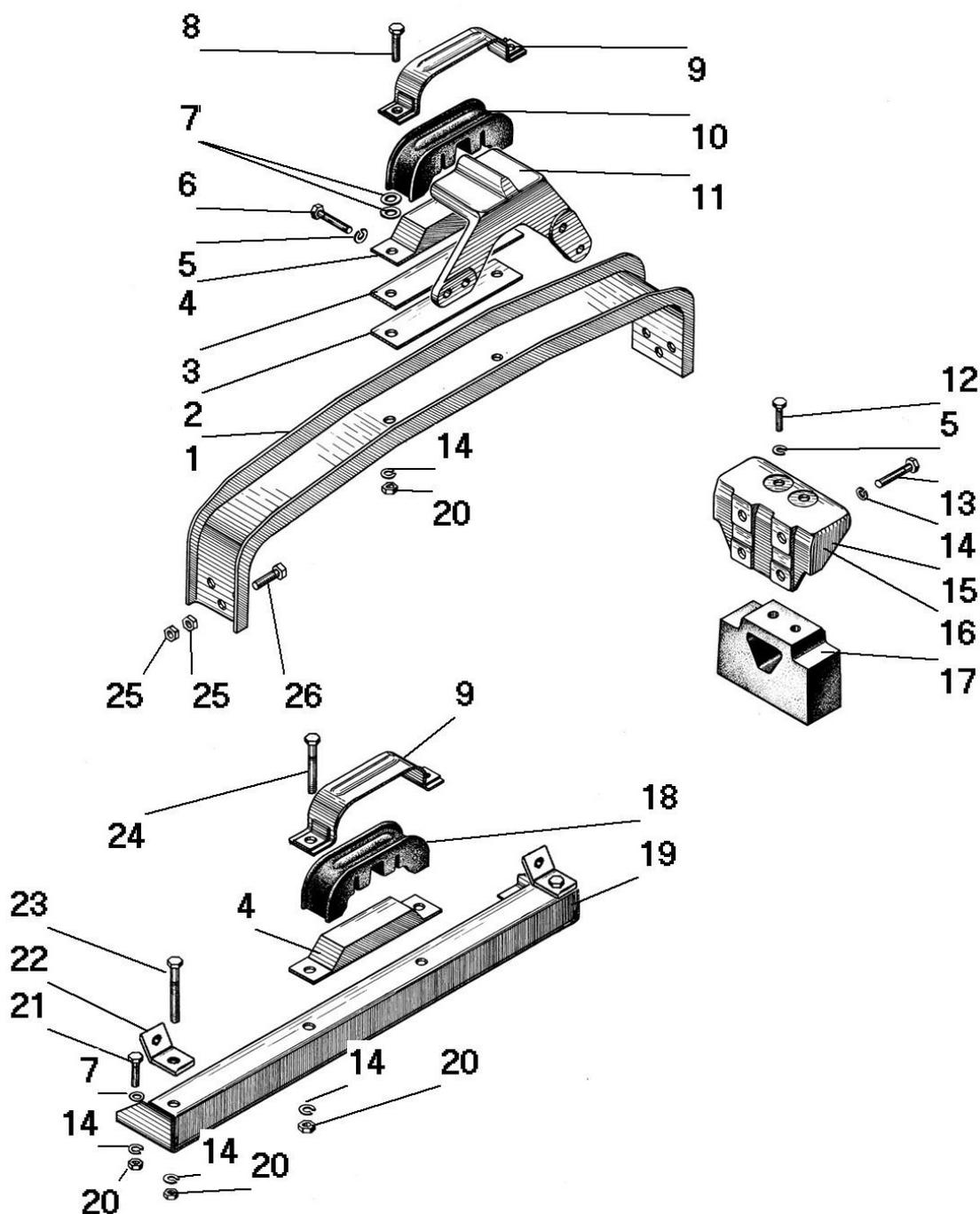
Рисунок 1 - Подвеска двигателя
