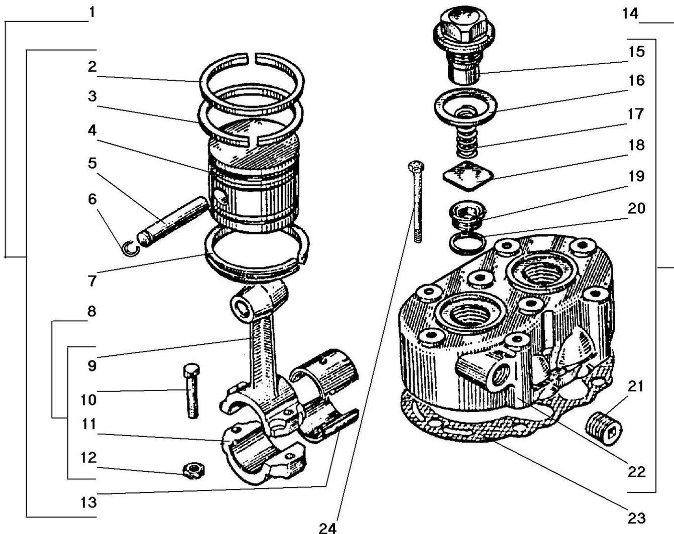
Рисунок 76 - Головка и поршень компрессора
