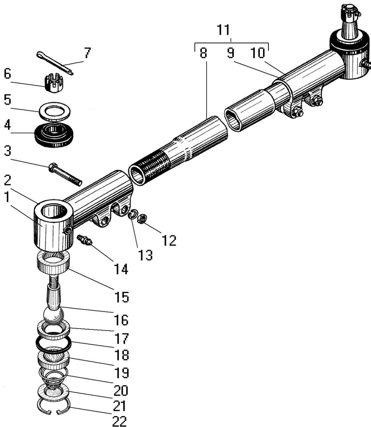
Рисунок 65 - Тяга рулевой трапеции
