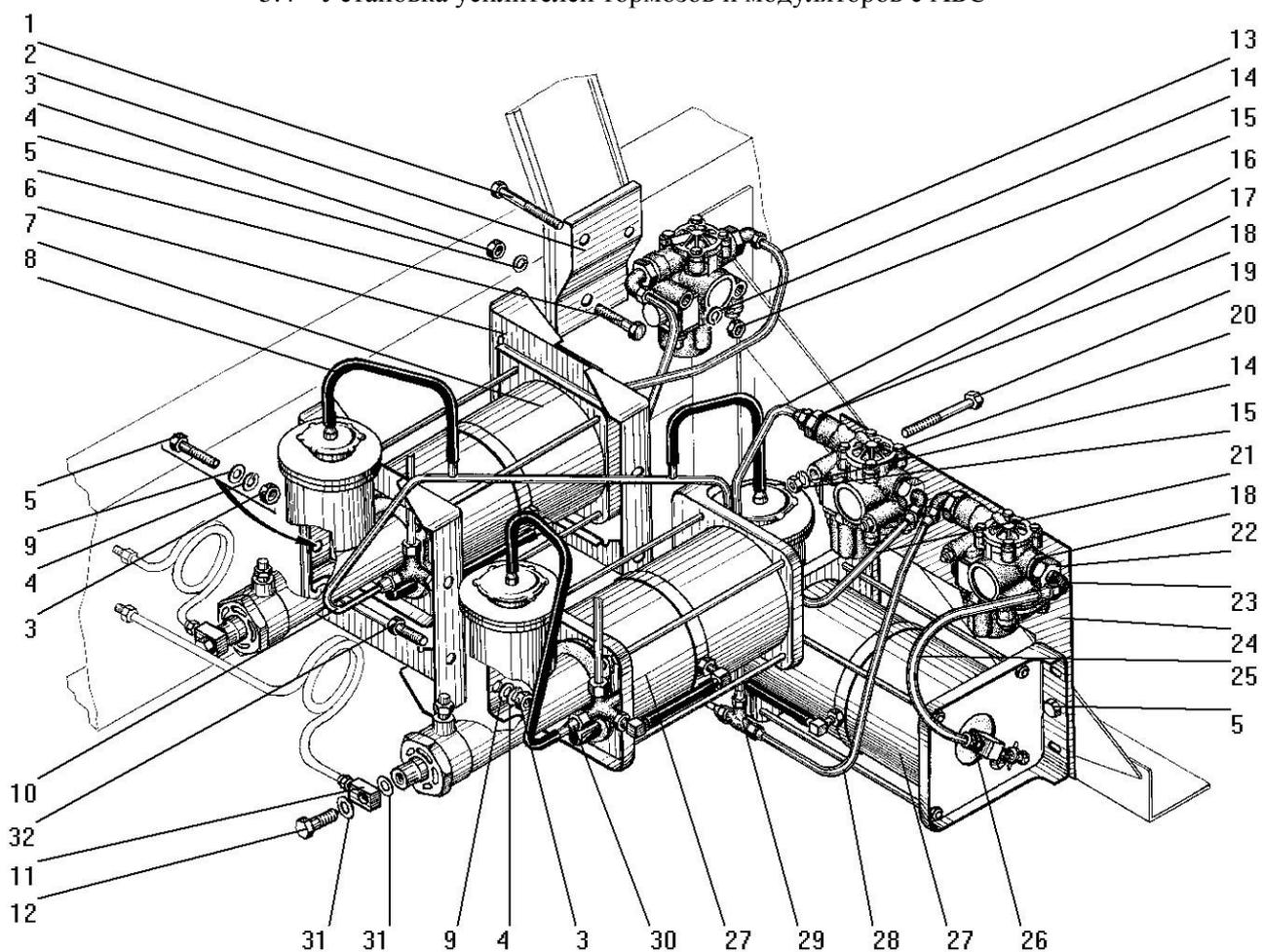
Рисунок 70 - Установка усилителей тормозов и модуляторов с АБС
