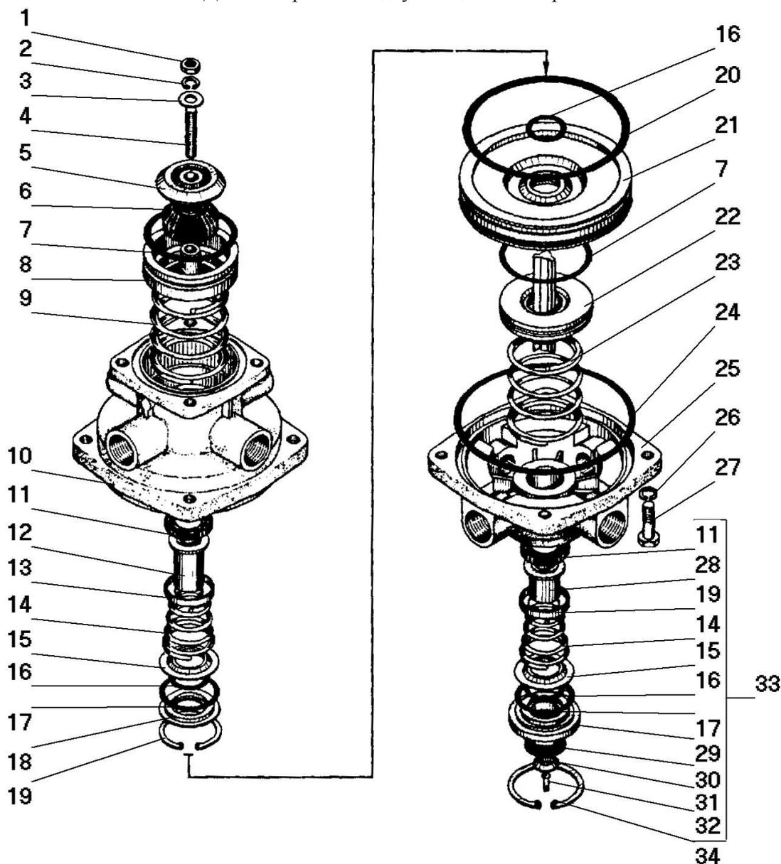
Рисунок 81 - Детали тормозного двухсекционного крана
