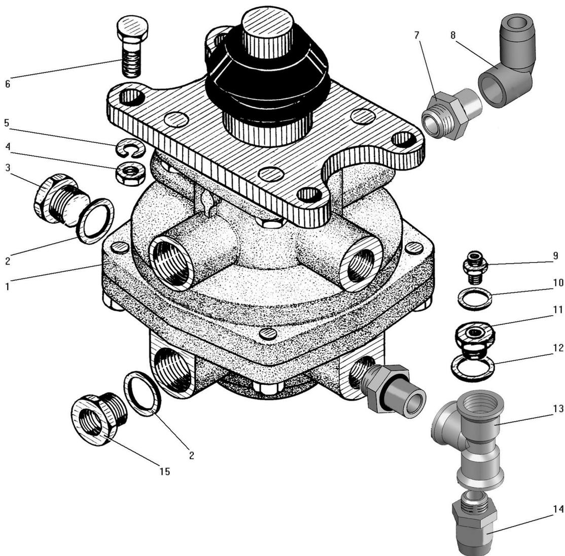
Рисунок 80 - Тормозной двухсекционный кран
