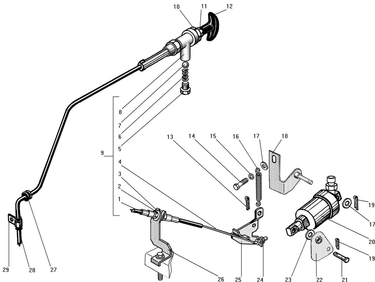
Рисунок 13 - Тяга ручного останова двигателя
