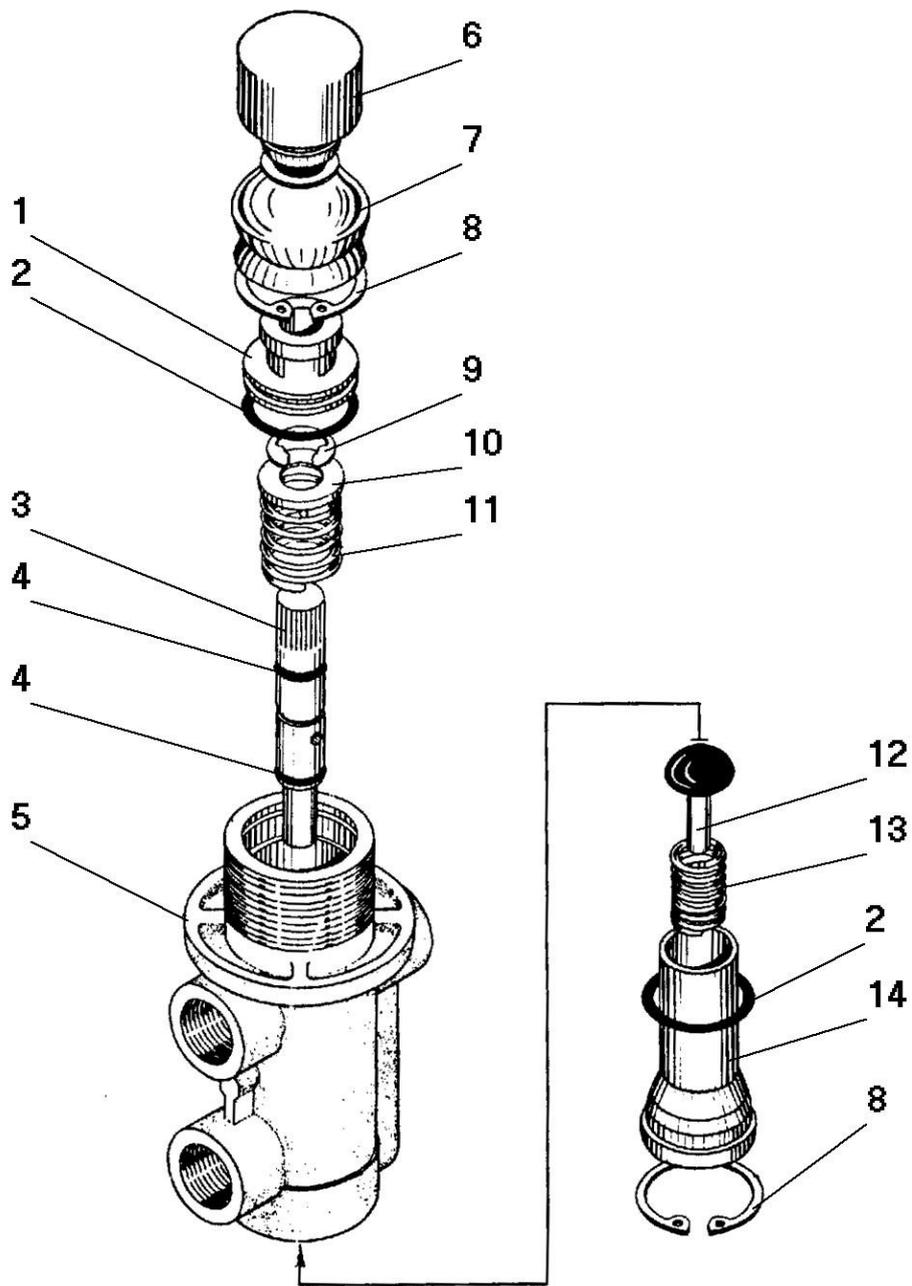
Рисунок 91 - Пневматический кран
