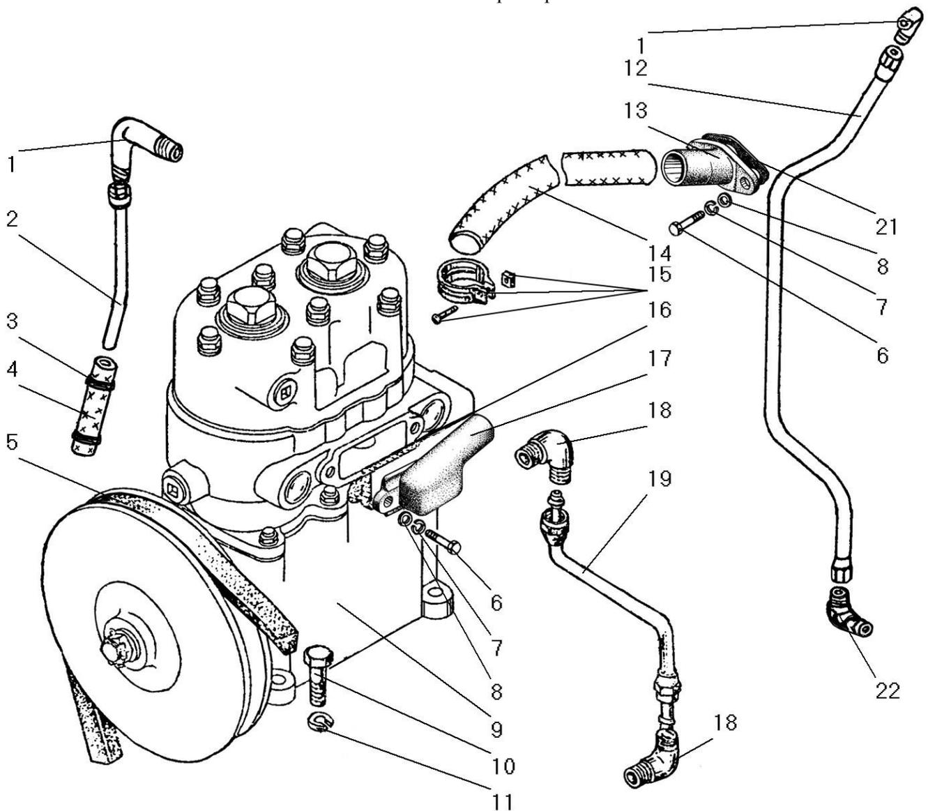
Рисунок 74 - Установка компрессора
