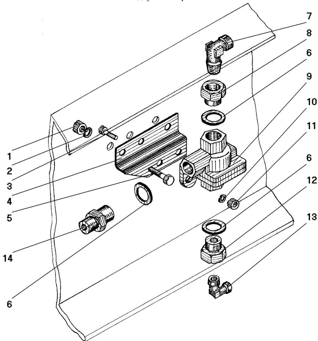
Рисунок 93 - Установка двухмагистрального клапана
