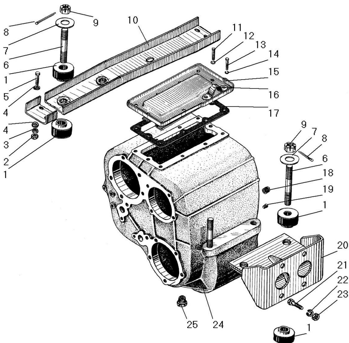
Рисунок 26 - Картер и подвеска раздаточной коробки
