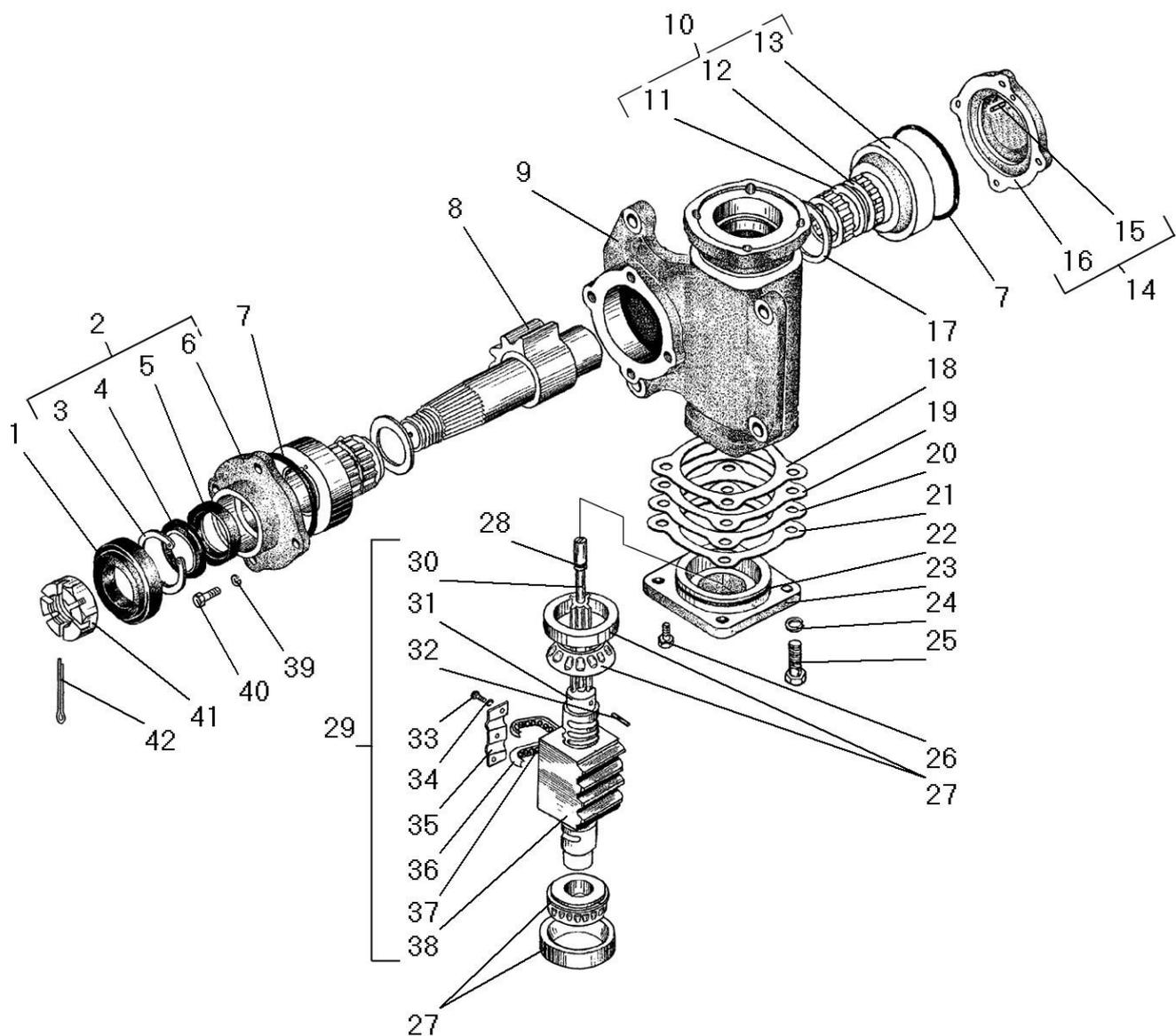
Рисунок 59 - Механизм рулевой
