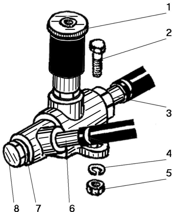
Рисунок 11 - Установка ручного насоса прокачки топлива
