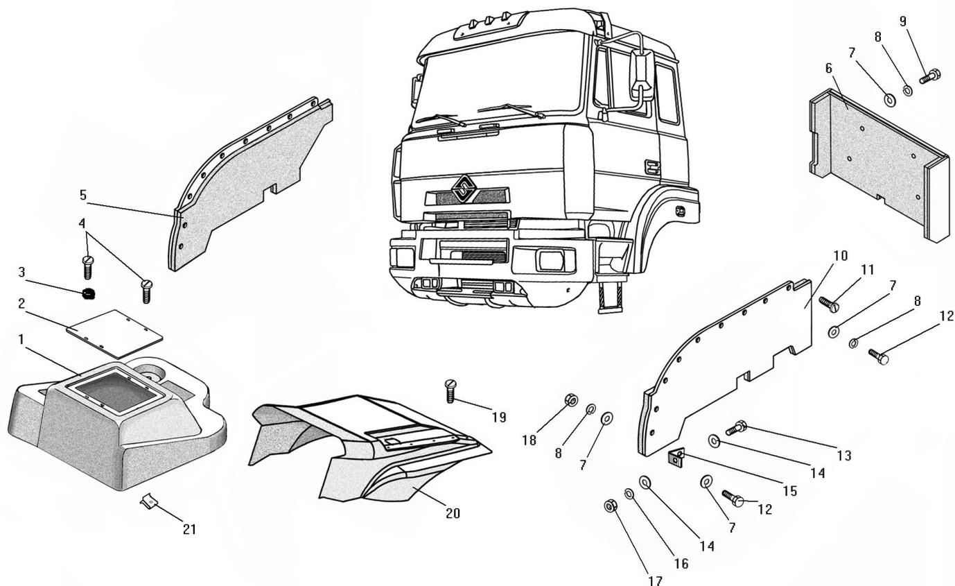
Рисунок 121 - Установка шумоизоляции
