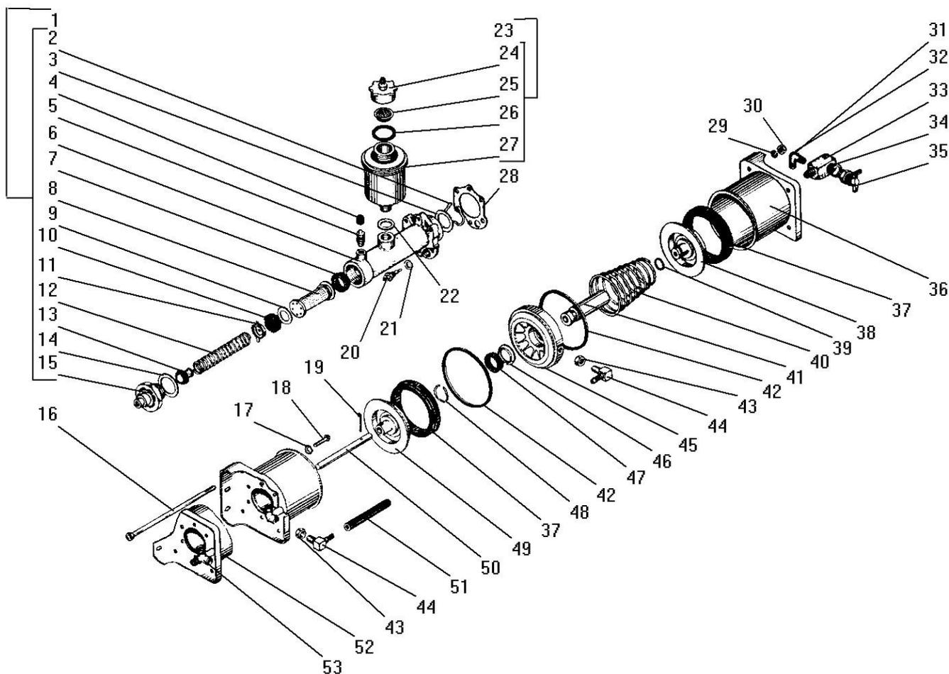
Рисунок 71 - Пневматический усилитель с главным тормозным цилиндром
