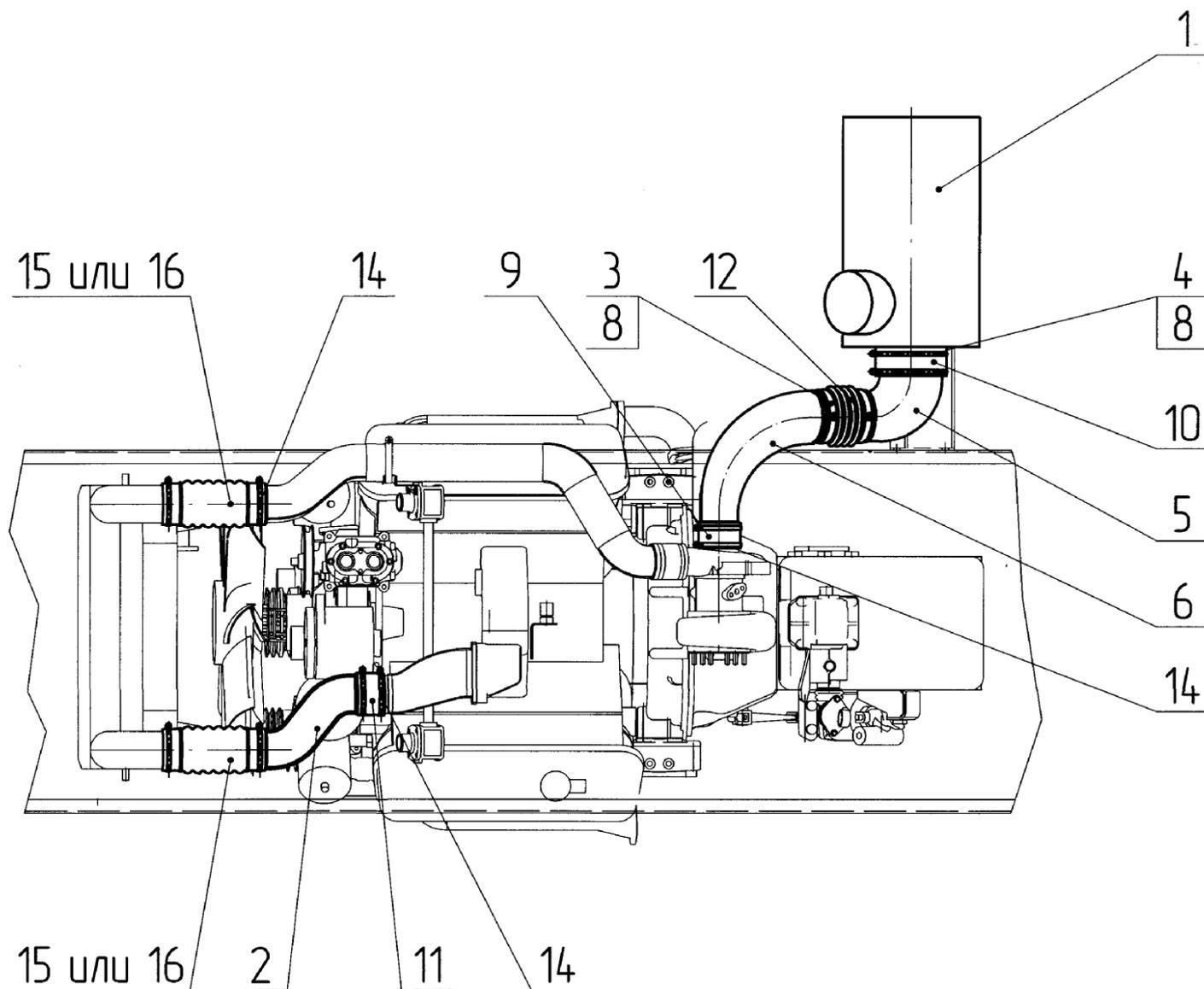
Рисунок 16 - система питания двигателя воздухом
