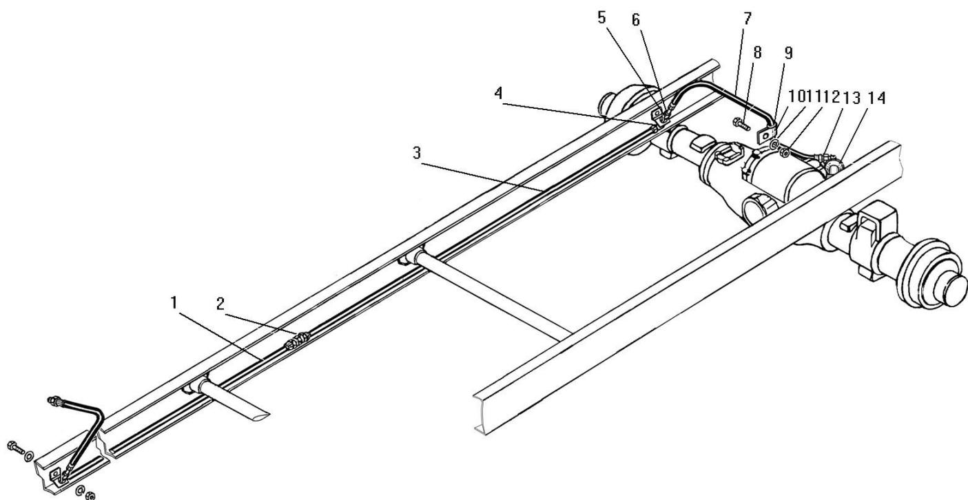
Рисунок 43 - Привод блокировки межколесных дифференциалов
