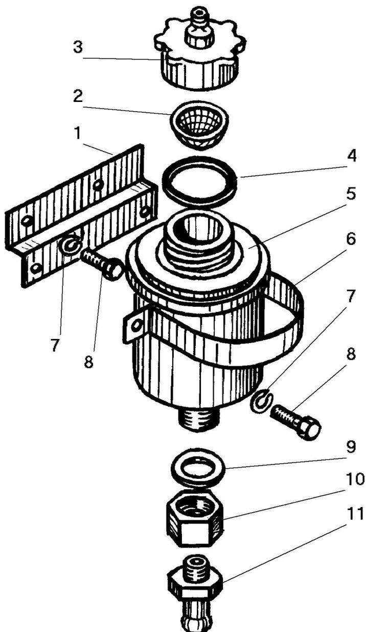
Рисунок 23 - Установка бачка привода сцепления
