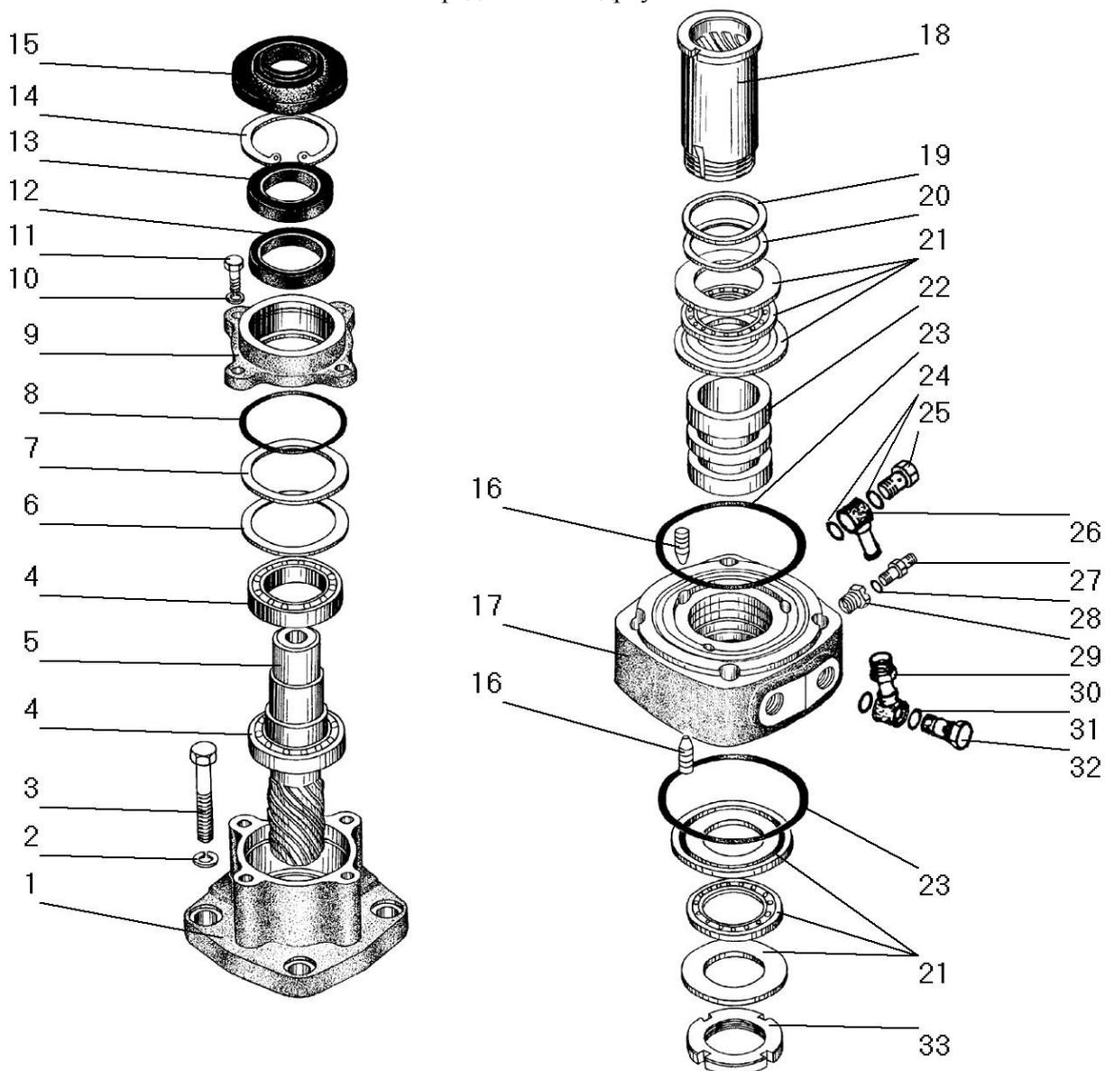
Рисунок 60 - Распределитель гидросилителя
