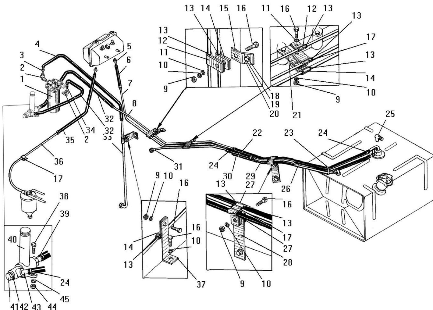
Рисунок 10 - Трубопроводы и шланги системы питания
