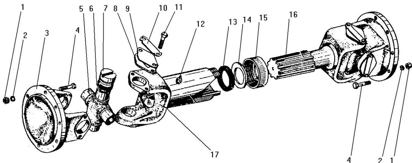
Рисунок 35 - Промежуточный карданный вал
