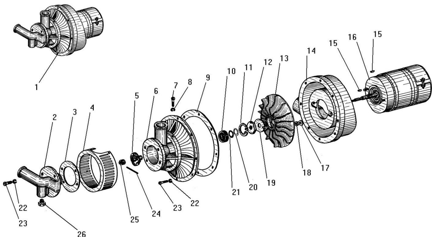
Рисунок 7 - Нагнетатель насосного агрегата
