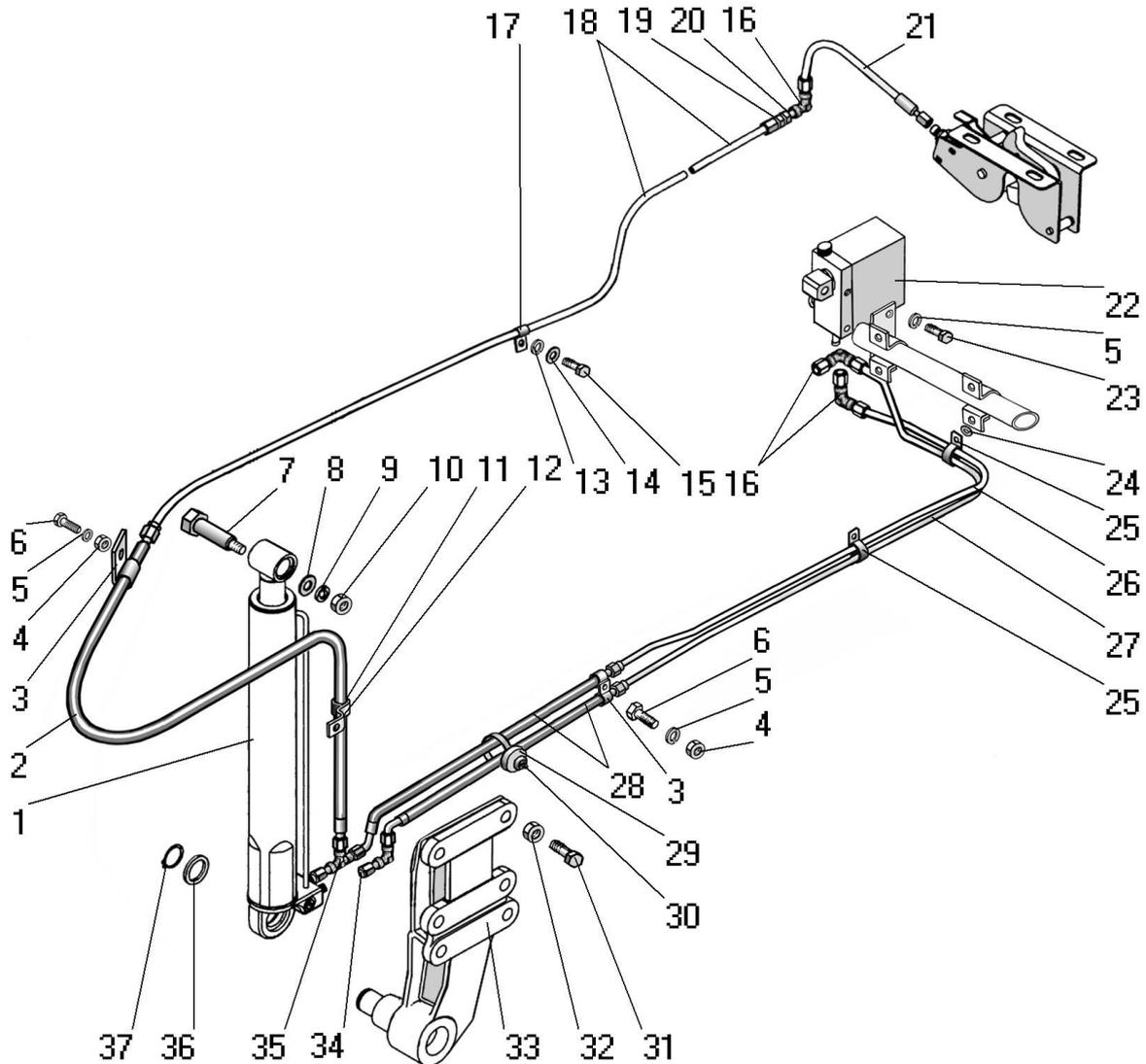
Рисунок 105 - Механизм опрокидывания кабины
