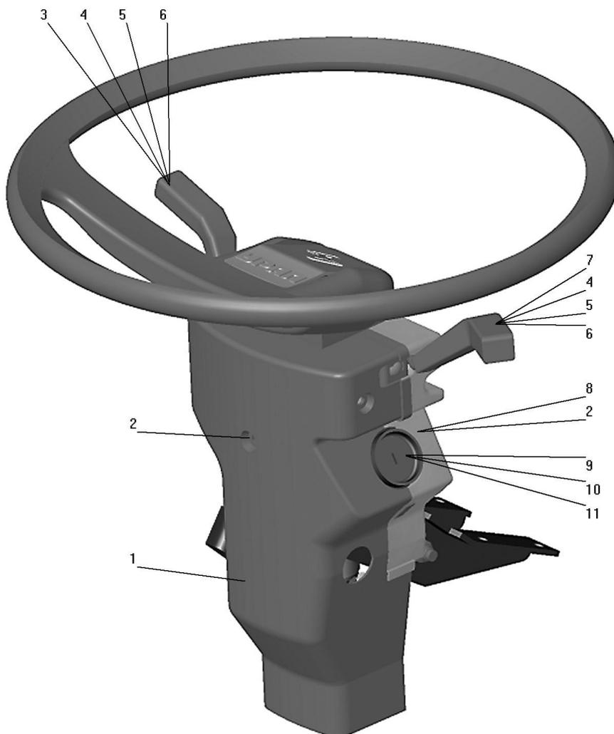
Рисунок 95 - Установка замка зажигания
