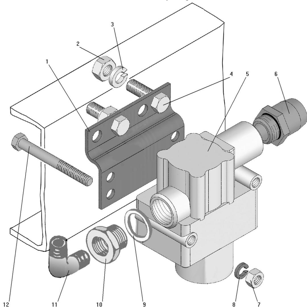
Рисунок 87 - Установка модулятора
