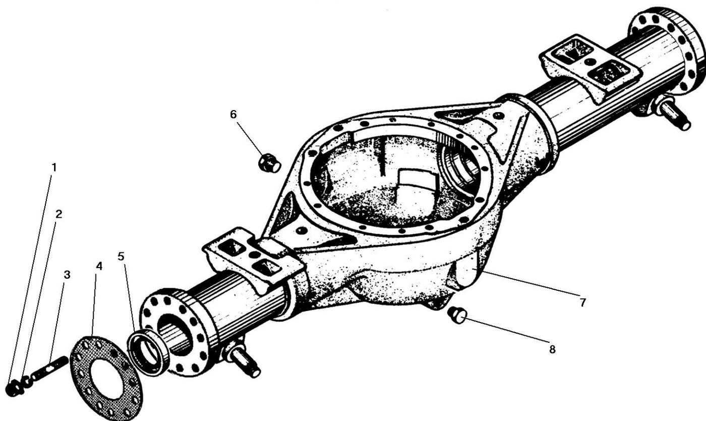
Рисунок 37 - Картер переднего моста
