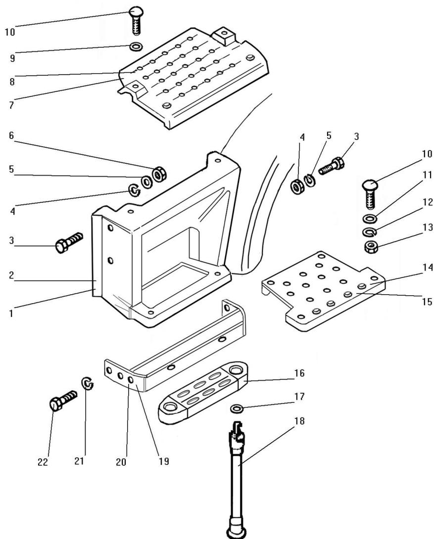
Рисунок 123 - Установка подножек
