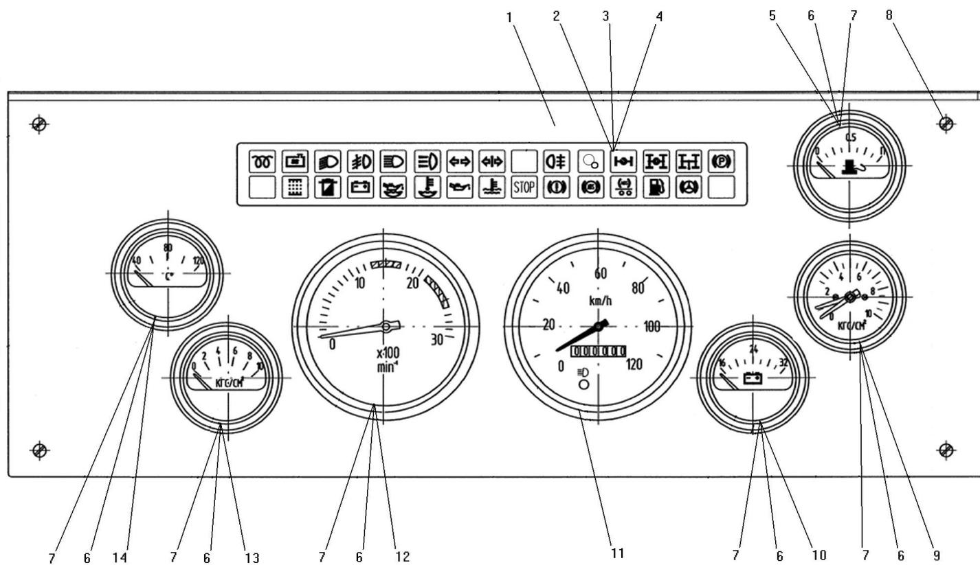
Рисунок 99 - Панель приборов
