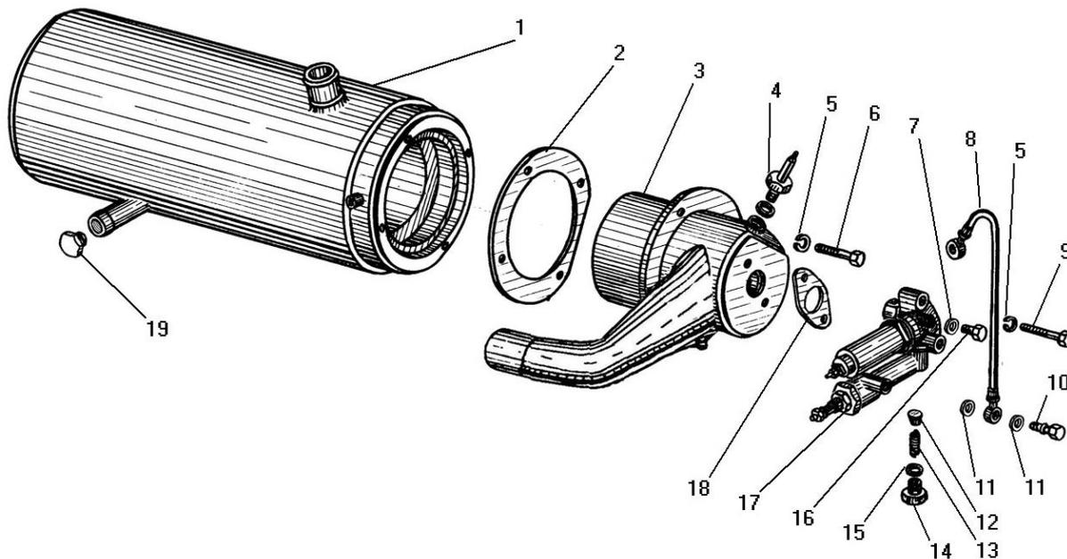
Рисунок 6 - Котел предпускового подогревателя
