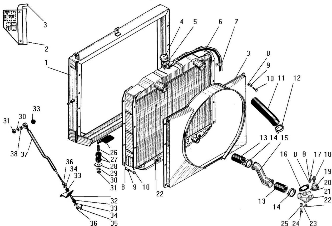
Рисунок 19 - Радиатор системы охлаждения
