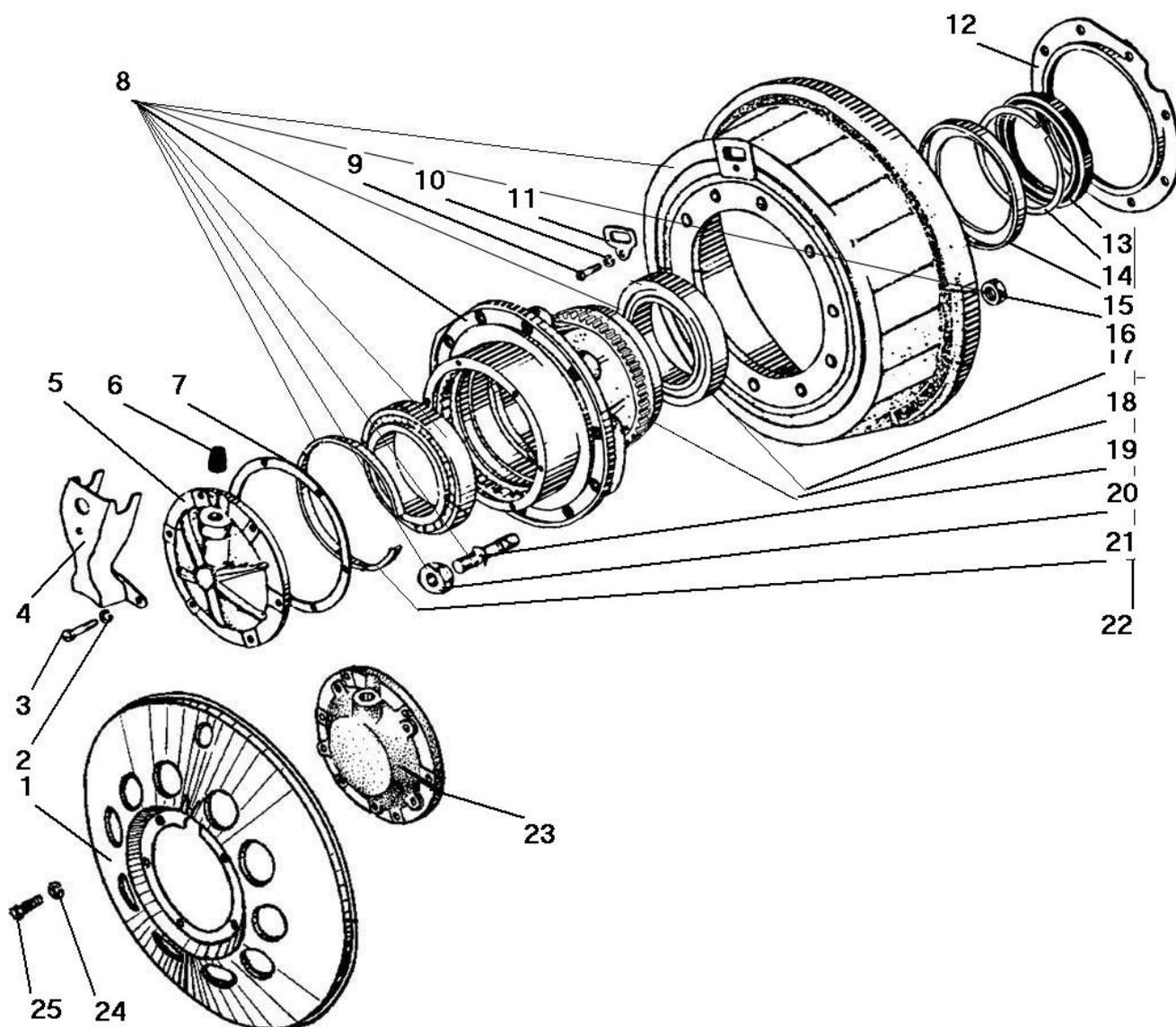
Рисунок 54 - Ступица колеса и тормозной барабан
