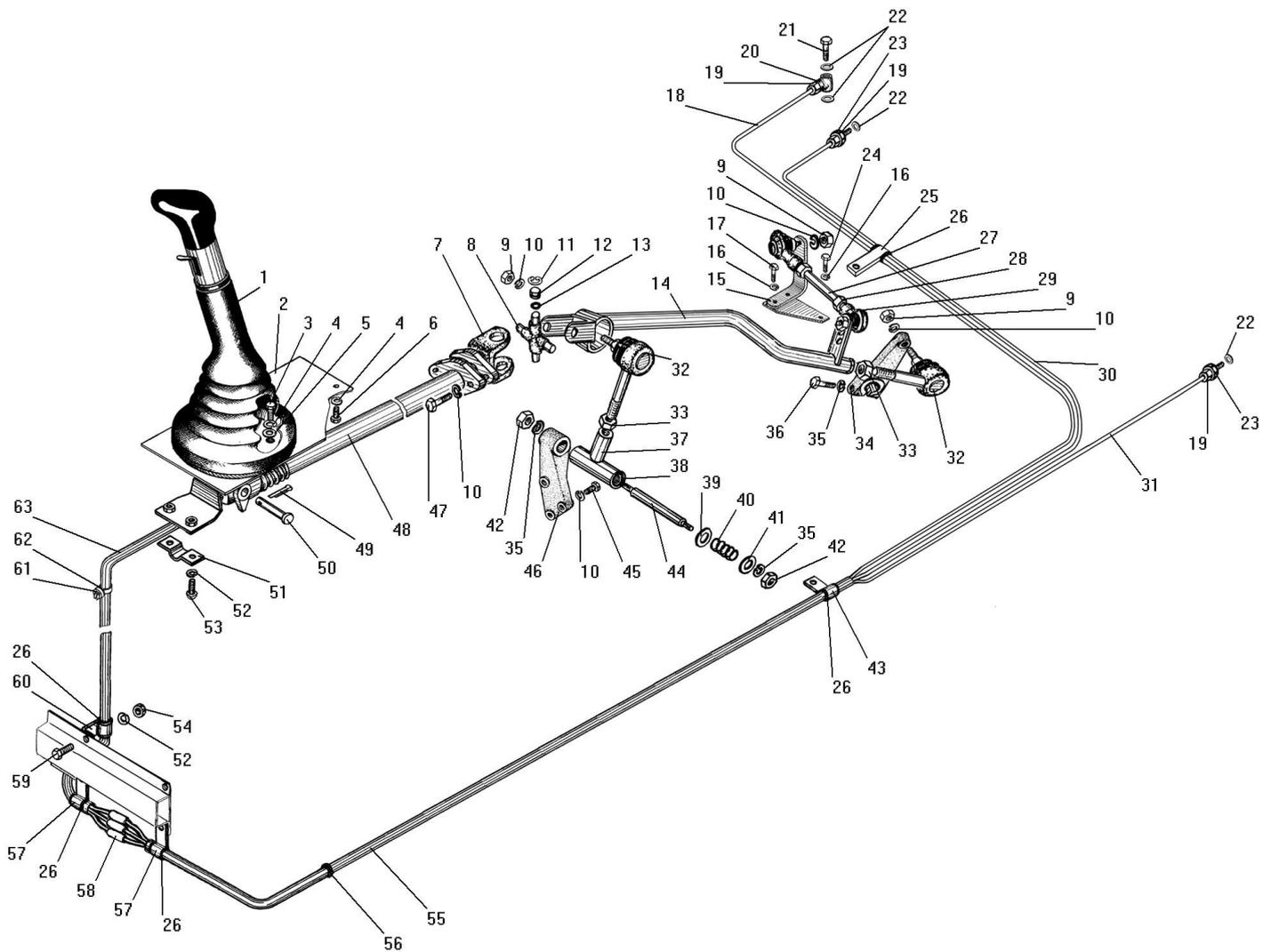
Рисунок 25 - Установка управления коробкой передач
