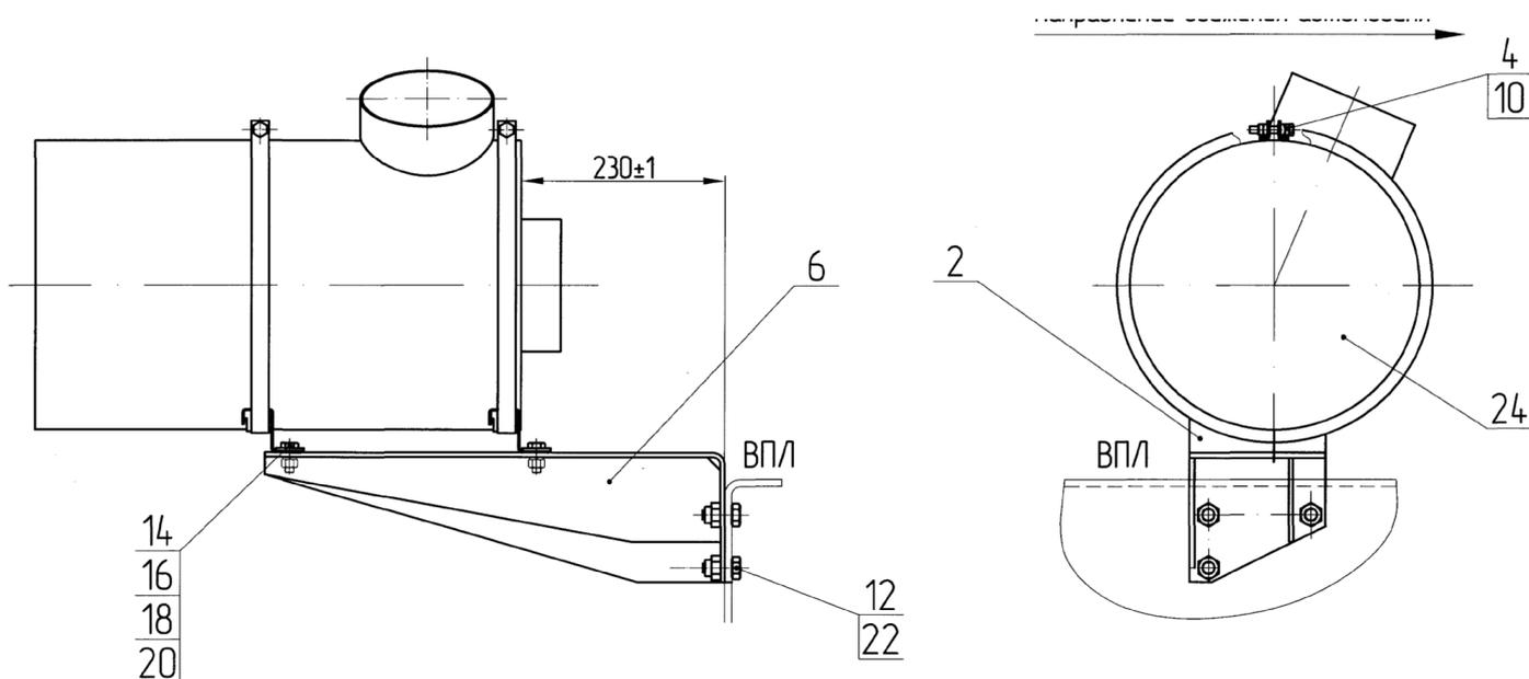
Рисунок 15 – Установка фильтра воздушного
