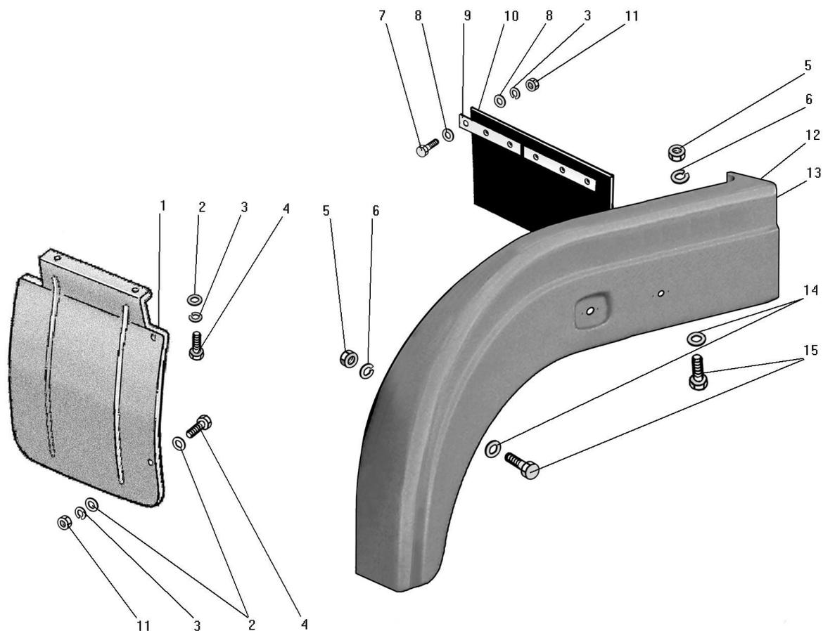
Рисунок 124 - Установка крыльев и брызговиков
