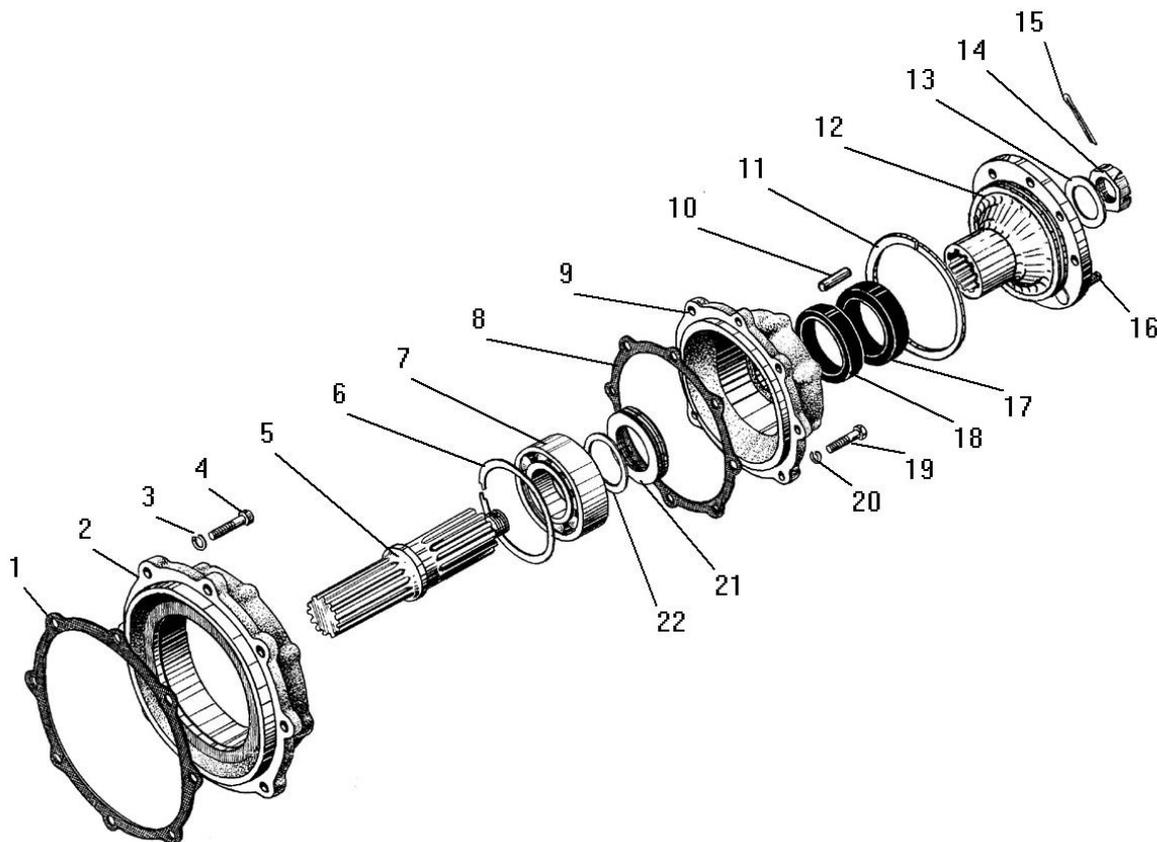
Рисунок 31 - Вал привода заднего моста раздаточной коробки
