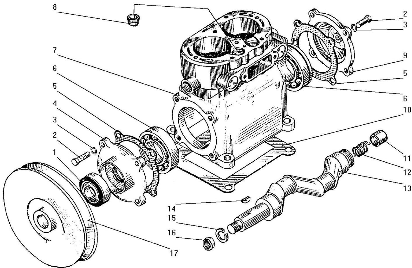
Рисунок 75 - Блок-картер компрессора
