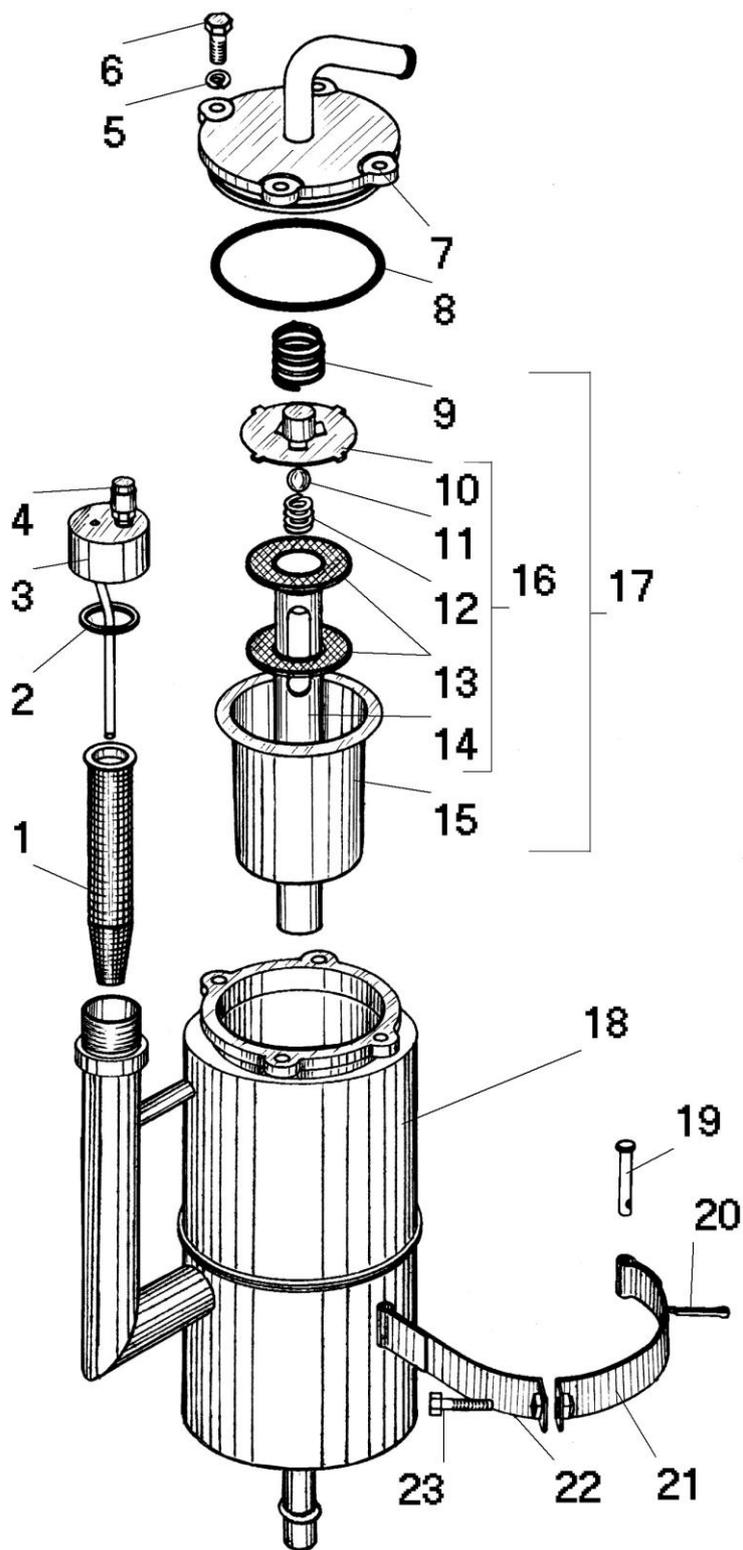
Рисунок 64 - Бак масляный рулевого механизма
