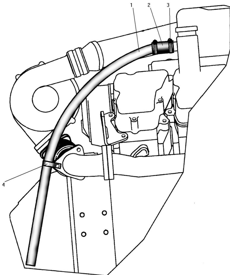
Рисунок 3 - Вентиляция картера
