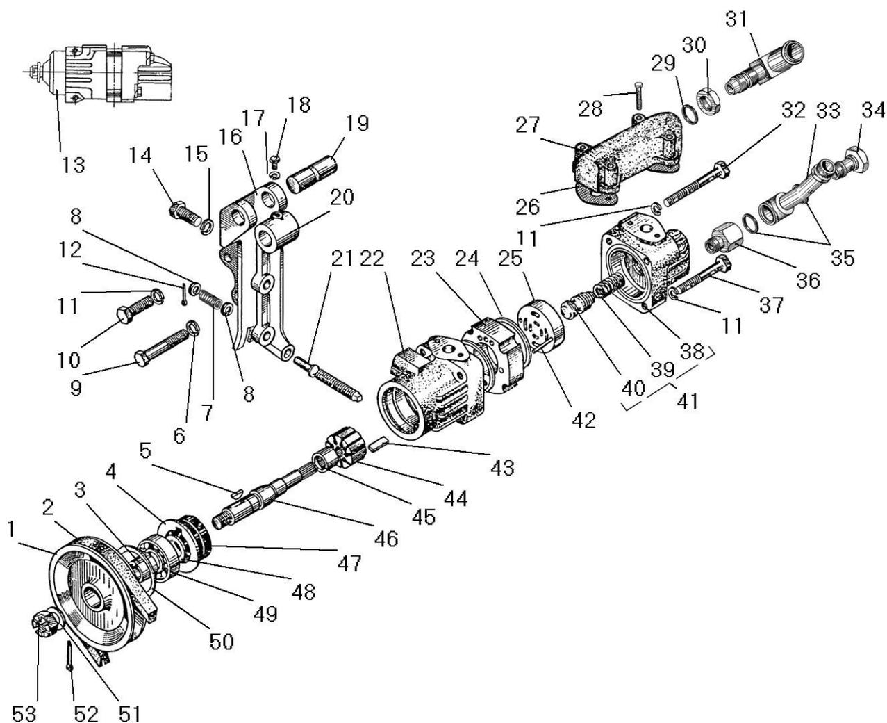
Рисунок 63 - Насос гидроусилителя руля
