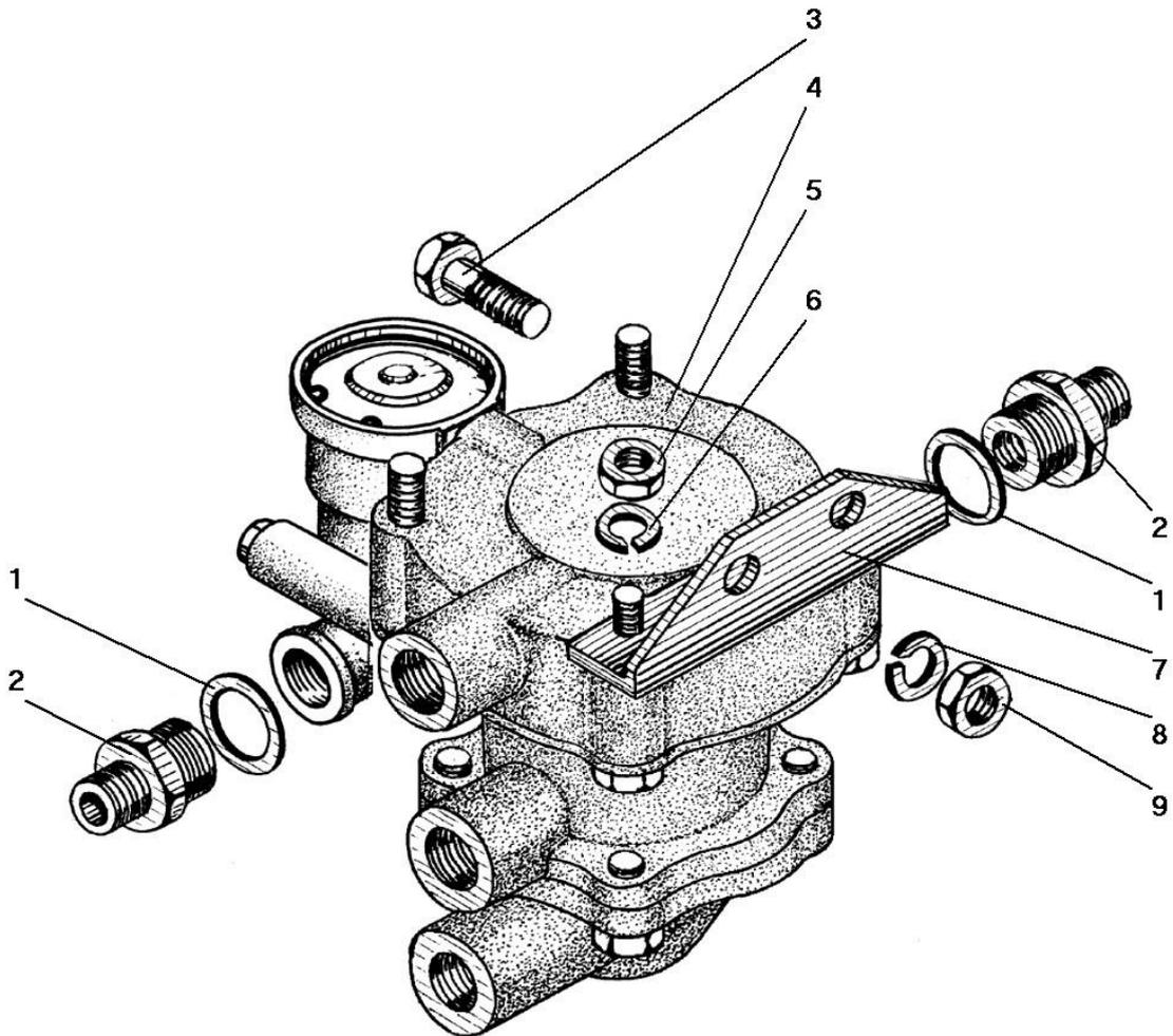
Рисунок 84 - Установка клапана прицепа с защитным клапаном
