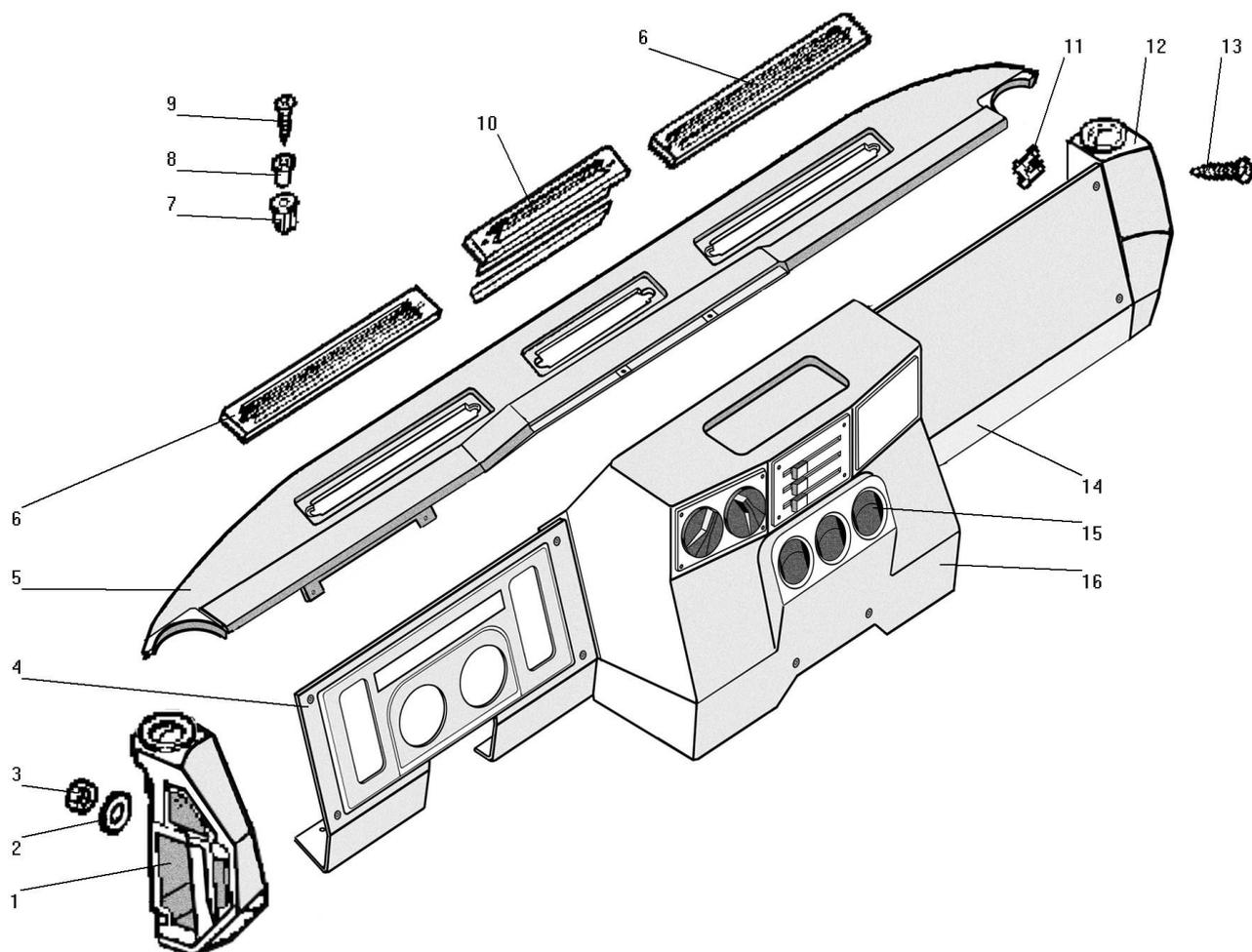
Рисунок 111 - Установка панели приборов
