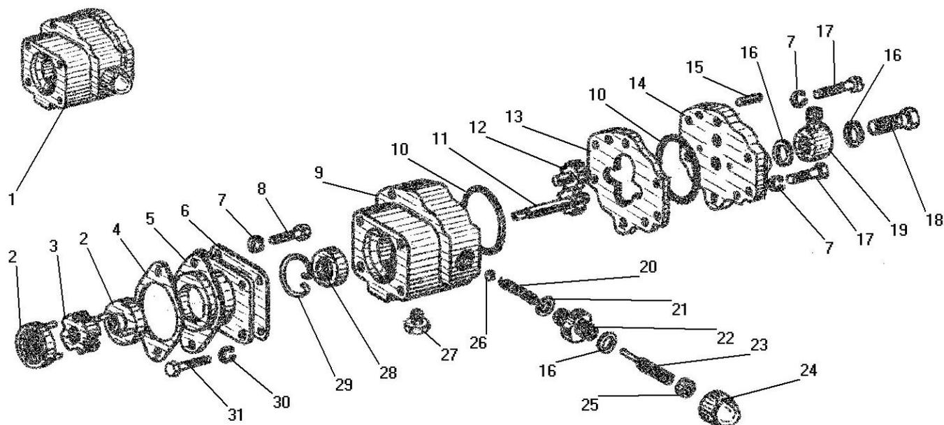
Рисунок 8 - Топливный насос насосного агрегата
