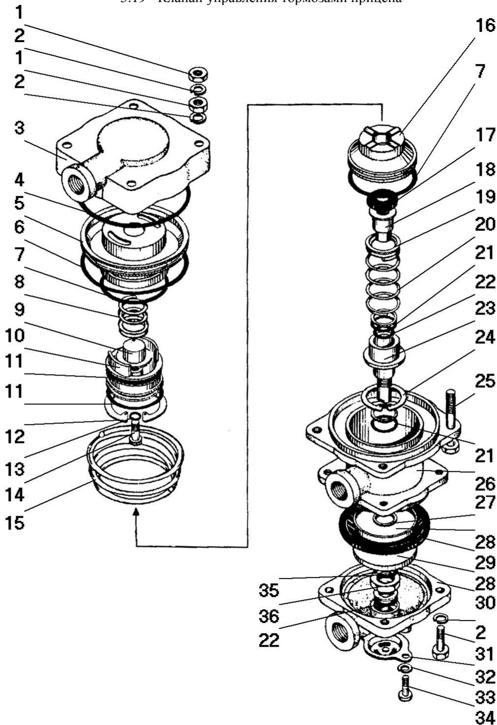
Рисунок 85 - Клапан управления тормозами прицепа
