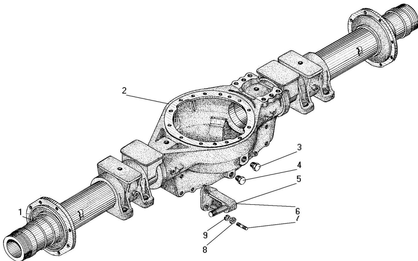
Рисунок 42 - Картер заднего моста
