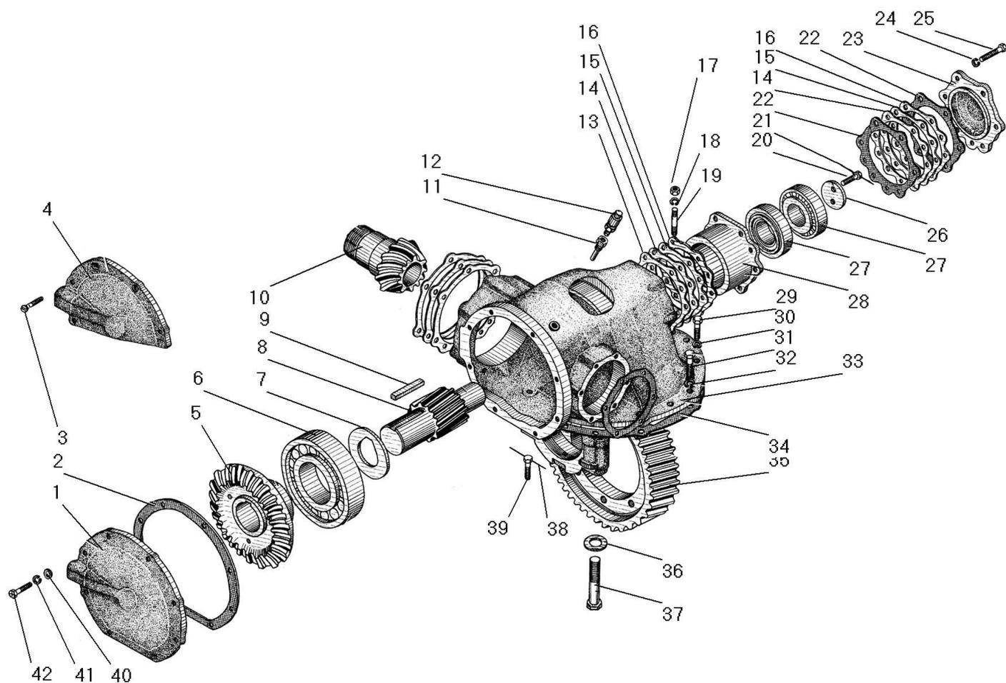
Рисунок 39 - Редуктор главной передачи
