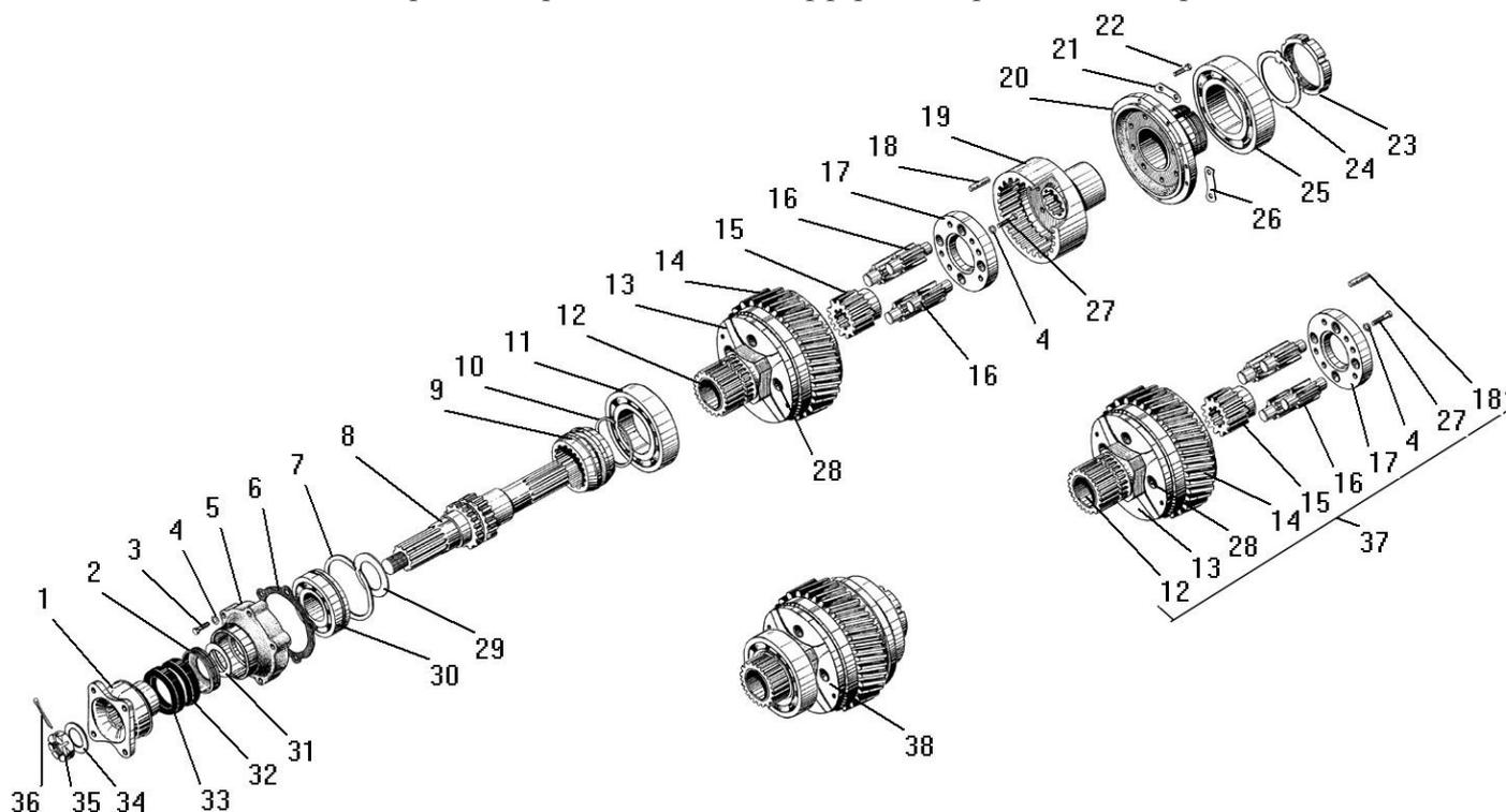
Рисунок 30 - Вал привода переднего моста и дифференциал раздаточной коробки
