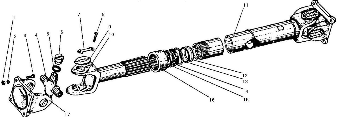
Рисунок 34 - Карданный вал переднего моста
