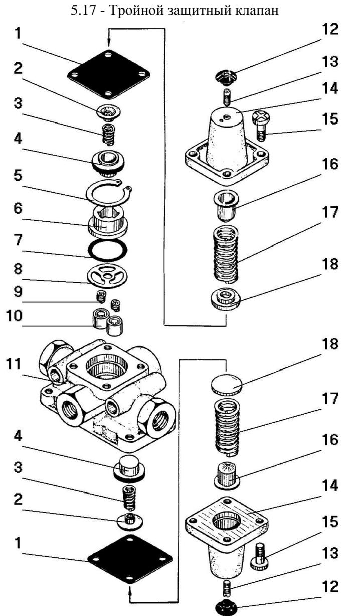
Рисунок 83 - Тройной защитный клапан
