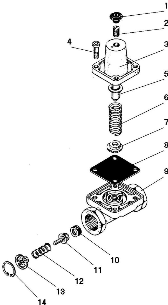
Рисунок 82 - Одинарный защитный клапан
