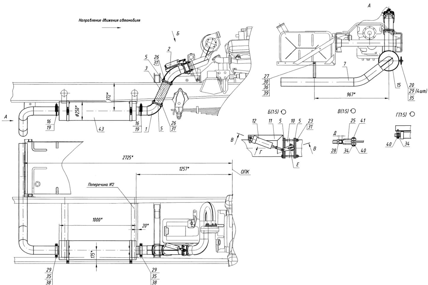
Рисунок 18 - Система выпуска газов
