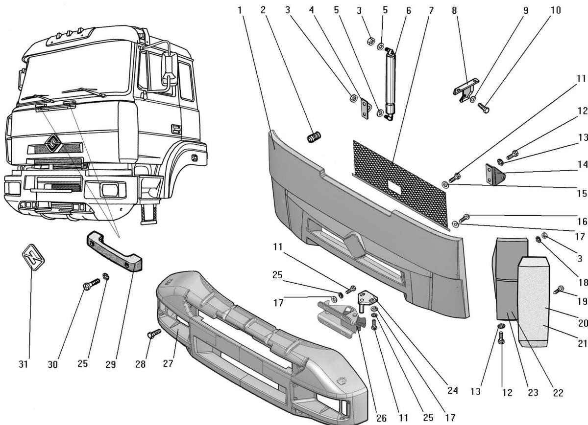
Рисунок 113 - Установка наружной облицовки
