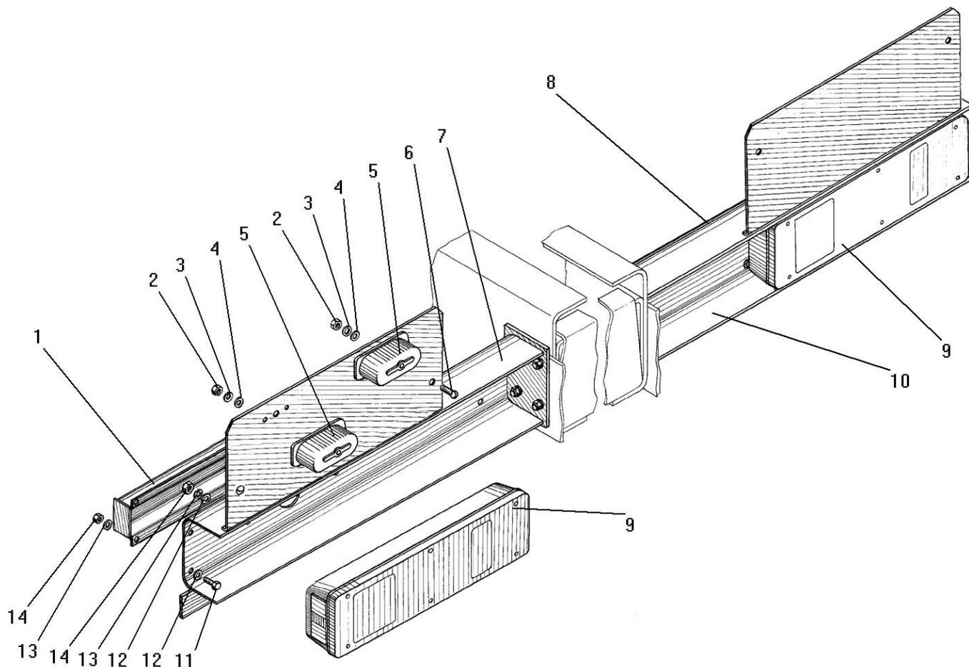
Рисунок 98 - Установка задних осветительных приборов
