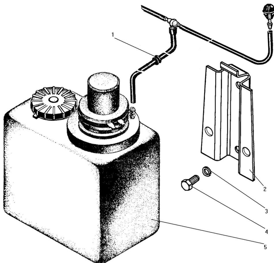
Рисунок 110 - Омыватель ветрового стекла
