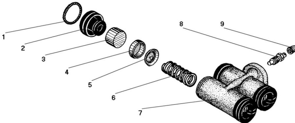
Рисунок 68 - Цилиндр колесный в сборе 375-3501030-01
