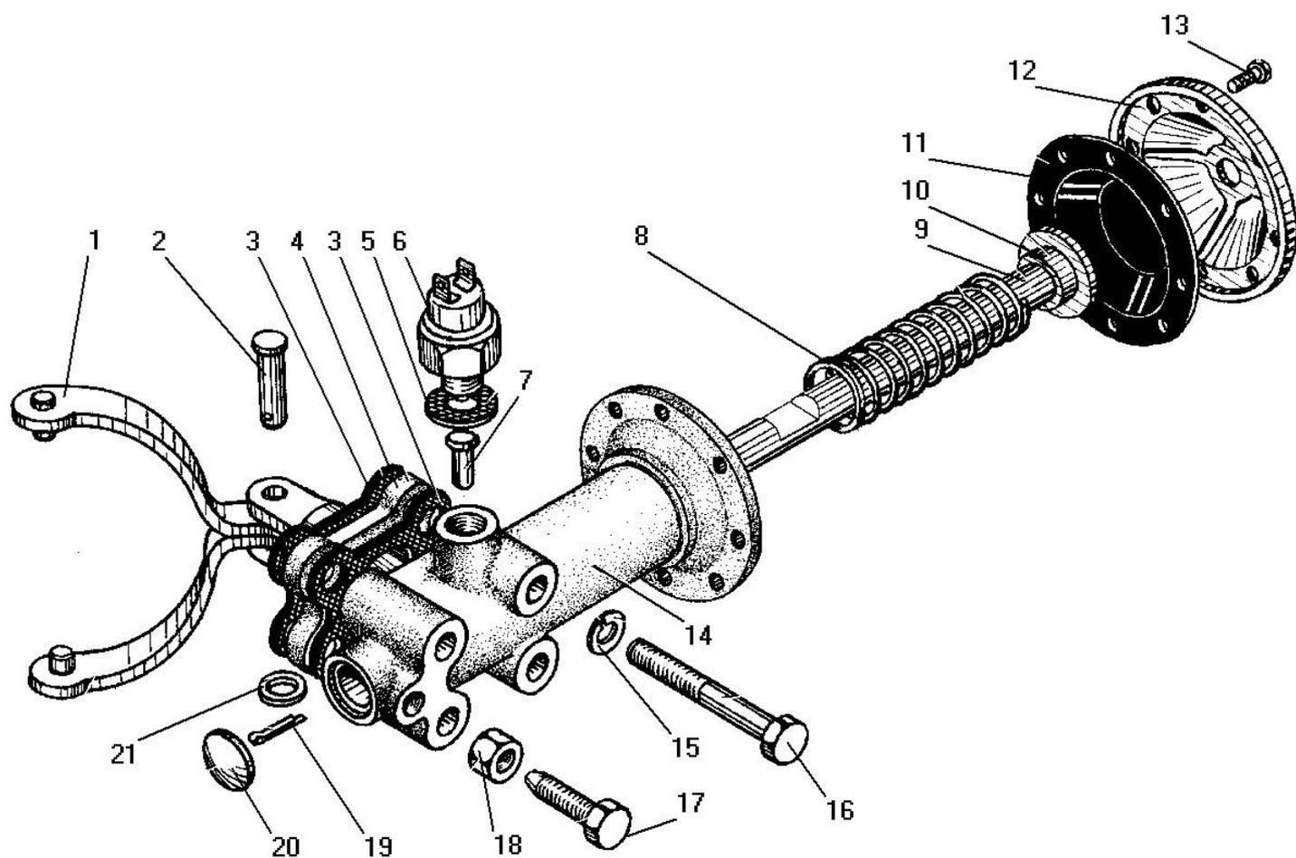
Рисунок 44 - Механизм включения блокировки дифференциала
