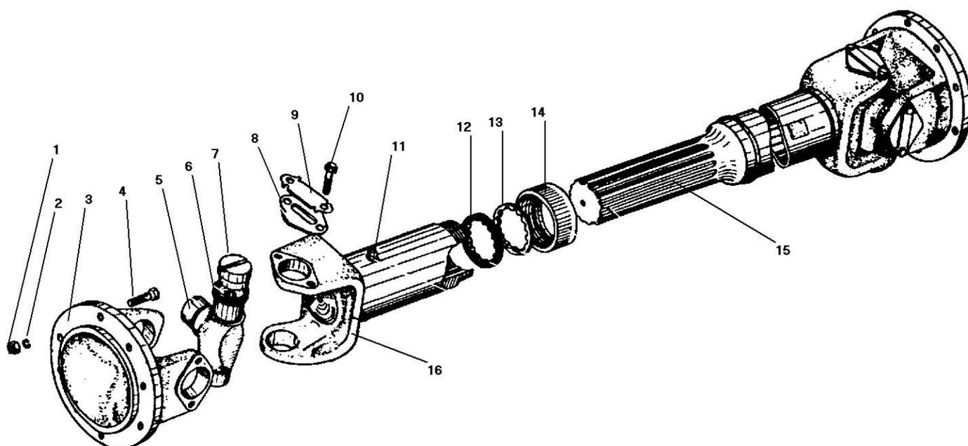
Рисунок 36 - Карданный вал заднего моста
