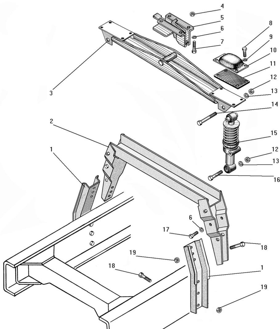
Рисунок 104 - Опора кабины задняя
